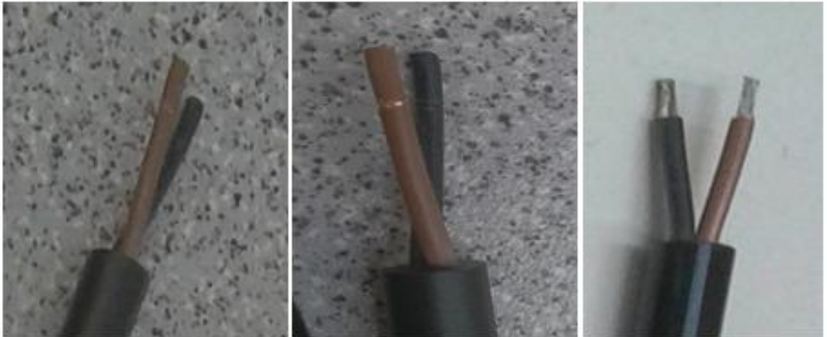
Obrázok 13 Vodič neodizolovaný, odizolovaný čiastočne a odizolovaný úplne (vlastné spracovanie)
