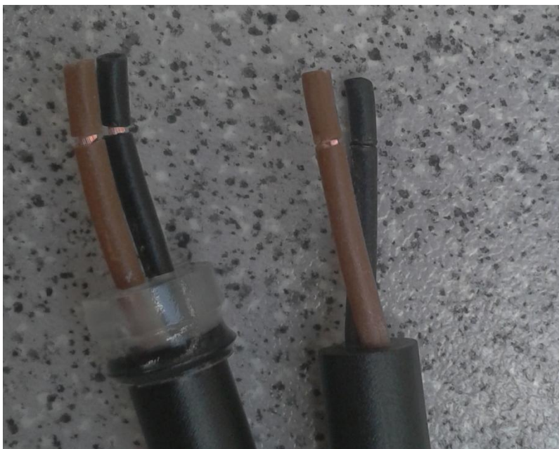
Obrázok 14 Kábel po a pred operáciou nástrek (vlastné spracovanie)
