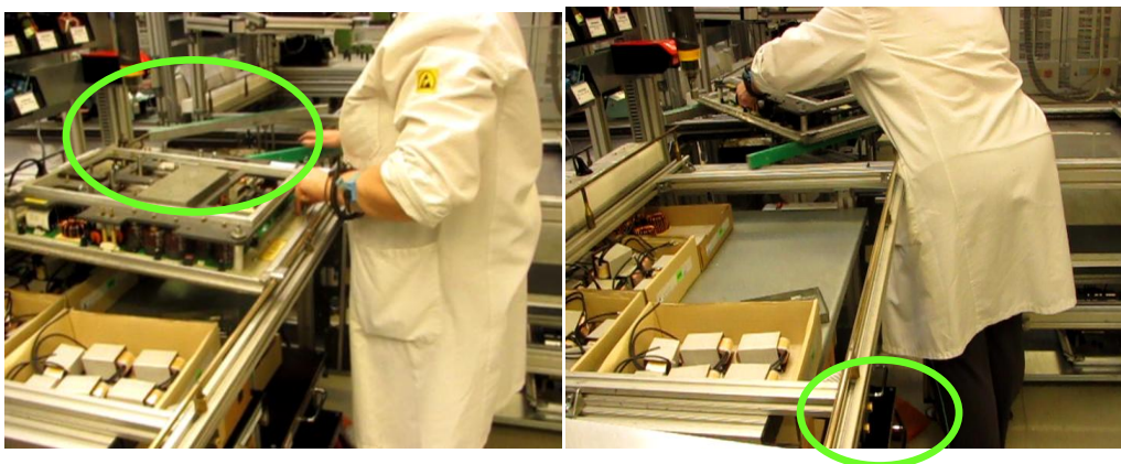
Obr. 50 Uloženie rámu na dopravník pomocou pneumatického zdvihača (Vlastné spracovanie)
