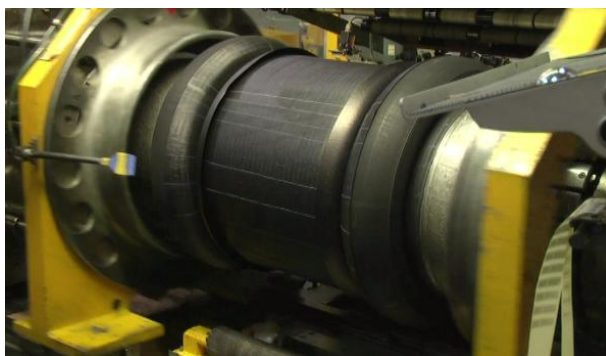
Obr. 29 Naražení patních lan a přehnutí okrajů kordu přes lana bočními přehýbávacími membránami (Interní materiál společnosti Continental Barum spol. s r.o. – film HTC konfekce)
