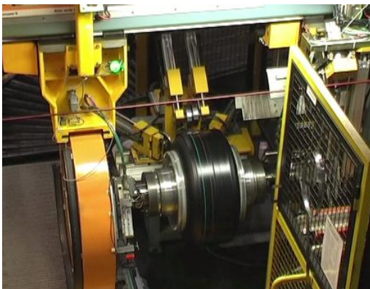
Obr. 36 Tvarování kostry pláště a přilepení nárazníkového prstence z běhounu na kostru pláště (Interní materiál společnosti Continental Barum spol. s r.o. – film HTC konfekce)
