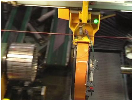
Obr. 35 Nájezd transferringu nad konfekční buben (Interní materiál společnosti Continental Barum spol. s r.o. – film HTC konfekce)
