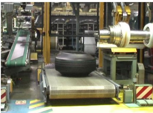
Obr. 37 Po dopravníku je plášť odváděn k poslednímu technologickému kroku (Interní materiál společnosti Continental Barum spol. s r.o. – film HTC konfekce)
