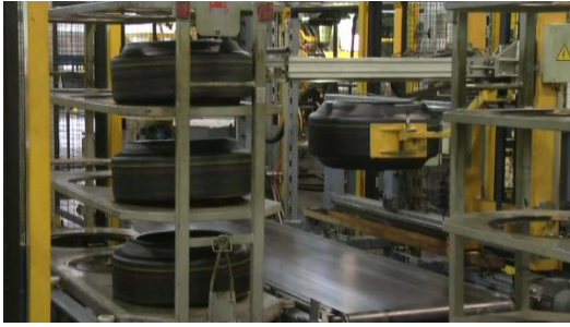
Obr. 39 Automatické založení pláštěů do vozíku (Interní materiál společnosti Continental Barum spol. s r.o. – film HTC konfekce)
