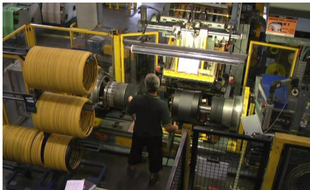
Obr. 28 Výroba kostry na prvním stupni konfekce (Interní materiál společnosti Continental Barum spol. s r.o. – film HTC konfekce)
