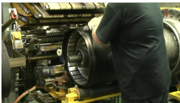
Obr. 30 Ruční spoj podle předpisu a přerádlování válečkem (Interní materiál společnosti Continental Barum spol. s r.o. – film HTC konfekce)
