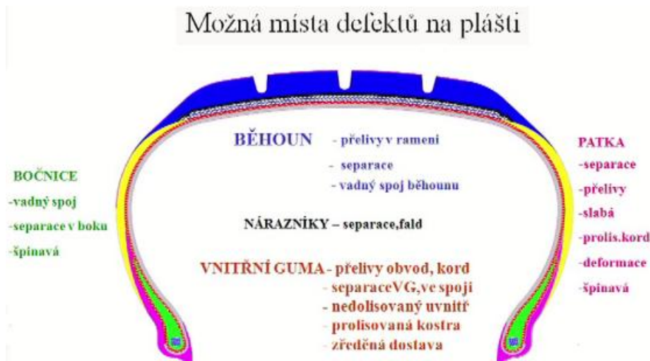
Obr. 27 Kritická místa pro vznik defektu na plášti (Interní materiál společnosti Continental Barum spol. s r.o. – film HTC konfekce)
