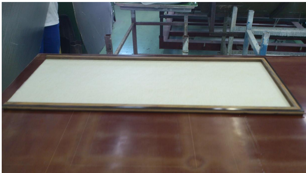
Obr. 76: Polohování jemné vrstvy prepregu a ustavení profilového rámu
