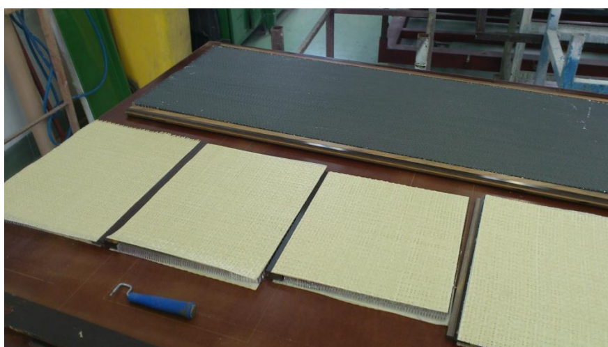
Obr. 84: Formovací stůl se vzorky a podlahovým panelem
