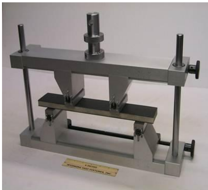
Obr. 41: Přípravek pro čtyřbodovou ohybovou zkoušku [40]
