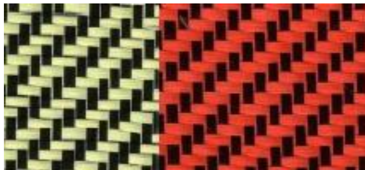
Obr. 7: Hybridní tkanina (kombinace uhlíkových a kevlarových vláken) [4]
