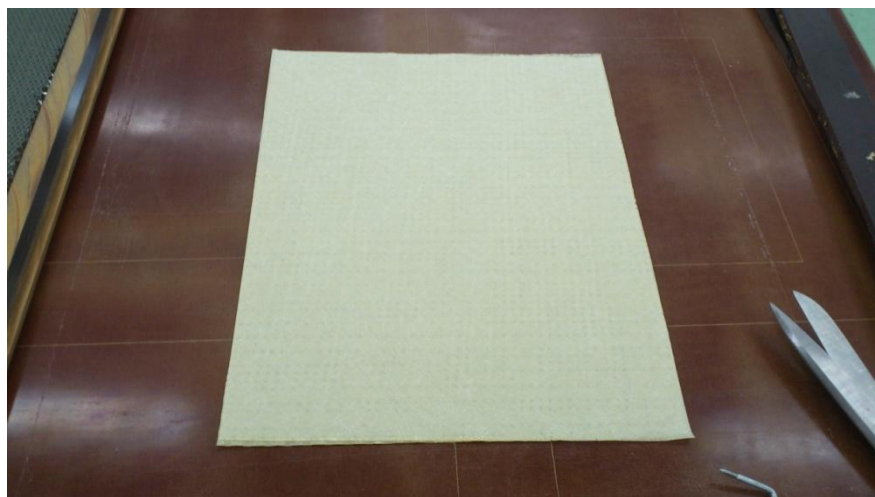
Obr. 80: Položení jemné vrstvy prepregu
