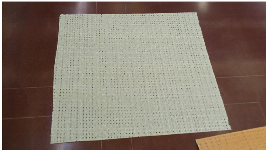
Obr. 79: Položení vnější hrubé vrstvy prepregu
