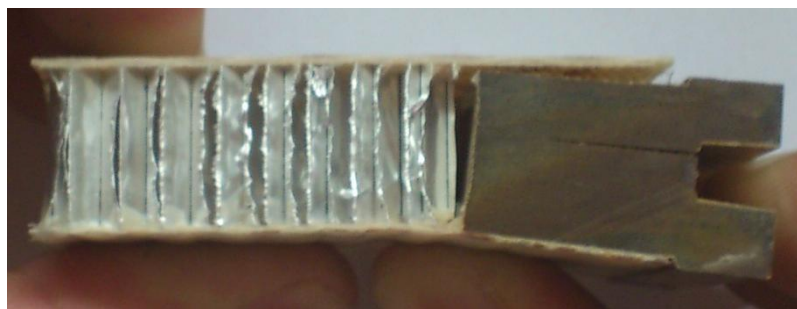
Obr. 98: Detail separovaného prepregu a prasknutého drážkového profilu
