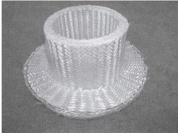
Obr. 8: Trojrozměrná výztuž příruby [4]
