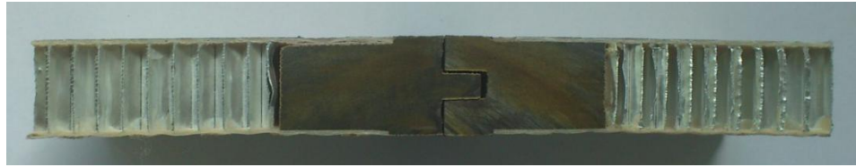
Obr. 89: Vzorek s tvarovým zámkem o profilech pero – drážka
