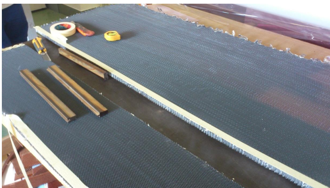
Obr. 77: Řezání voštiny na požadovaný rozměr
