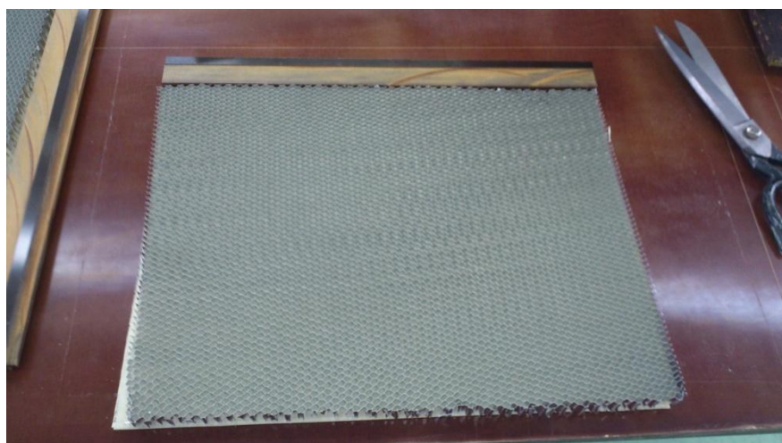
Obr. 81: Polohování voštinového jádra a tvarového profilu
