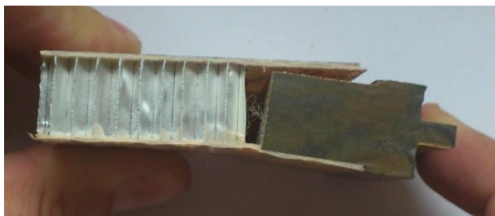
Obr. 94: Detail separovaného prepregu na části s perem
