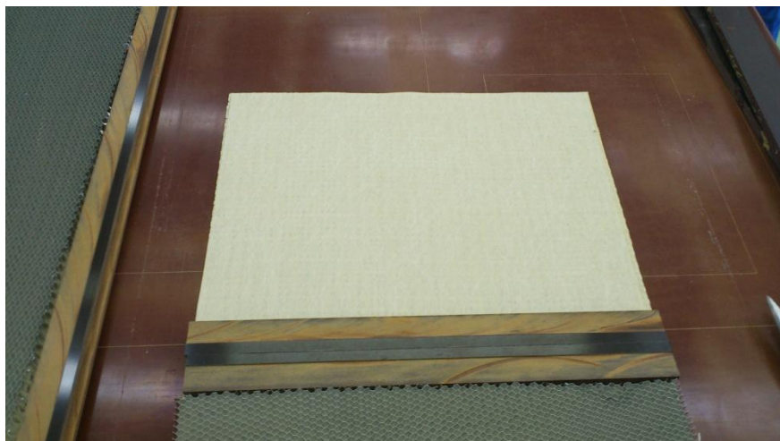
Obr. 82: Položení další vrstvy jemného prepregu
