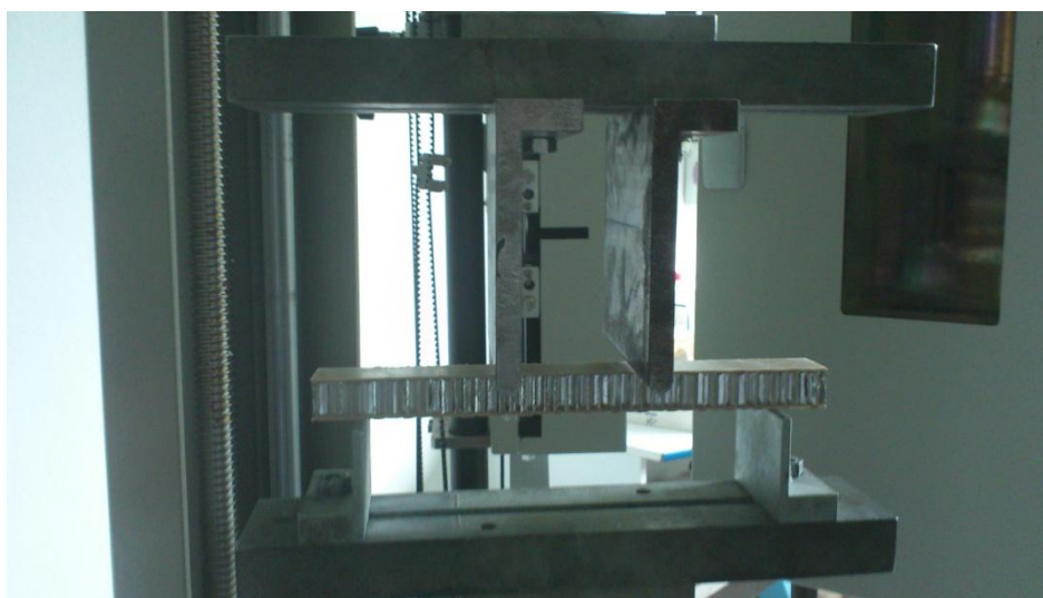
Obr. 115: Průběh testování čtyřbodovým ohybem
