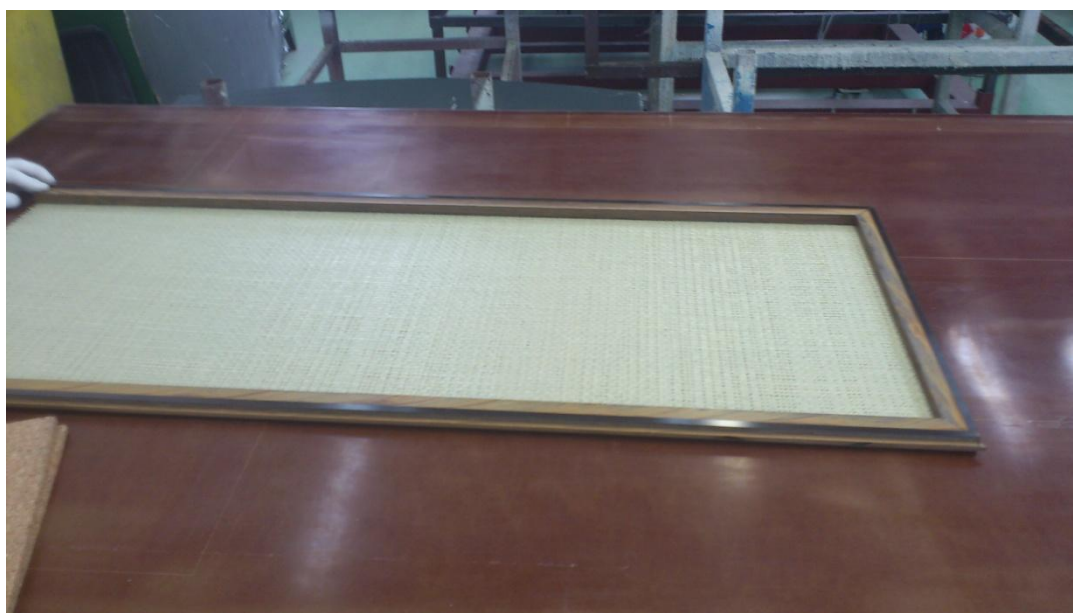
Obr. 75: Polohování hrubé vrstvy prepregu a optická zkouška rozměrů v porovnání s profilovým rámem
