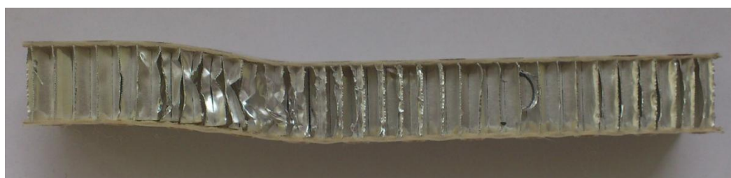
Obr. 110: Ukázka vzorku – separace obou vrstev prepregu a deformace ve formě zvlnění voštinového jádra
