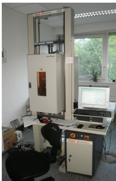
Obr. 85: Testovací stroj Zwick 1456
