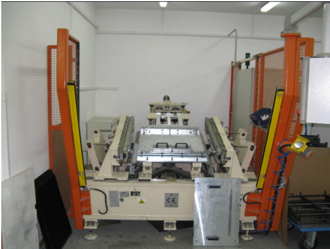
Obr. 21 Poloautomatický stroj na skládání vložek chladiče
