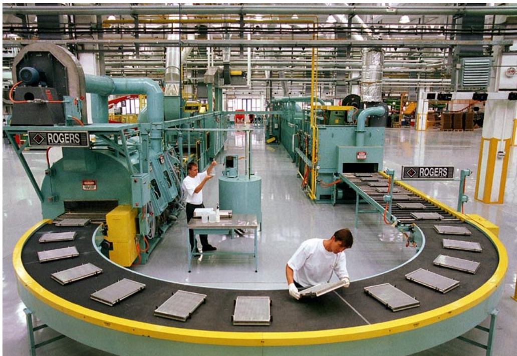
Obr. 7 Průběžná pájecí pec pro tvrdé pájení hliníku v ochranné atmosféře dusíku [20]
