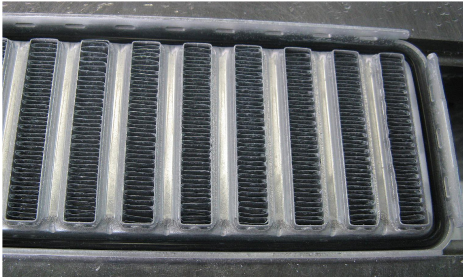
Obr. 15 Detail těsnění umístěného ve víku mezichladiče
