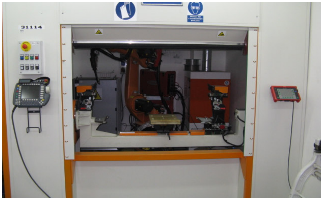
Obr. 25 Robotické svářecí pracoviště
