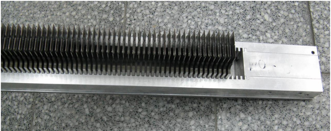
Obr. 22 Rozlemovací nože- součást sady nástrojů na výrobu chladiče
