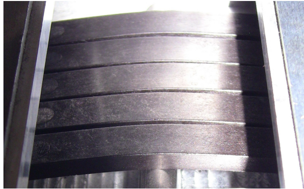
Obr. 57. PA 66 GF25 - Koroze pod napětím v referenčním prostředí
