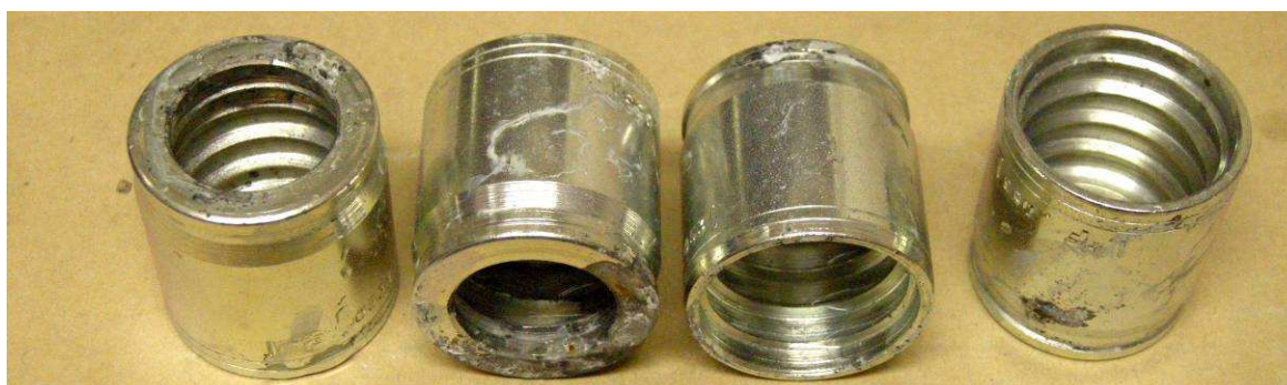
Obr.22. Povrch z kyselé lázně po 144h (stopy bílé koroze)
