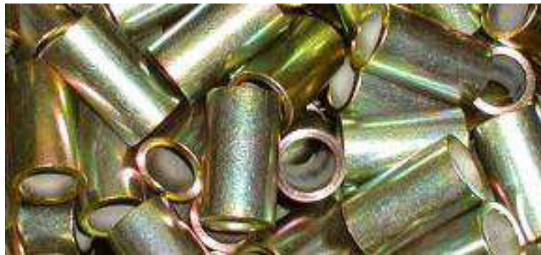
Obr. 12 Ukázka silnovrstvé žluté pasivace
