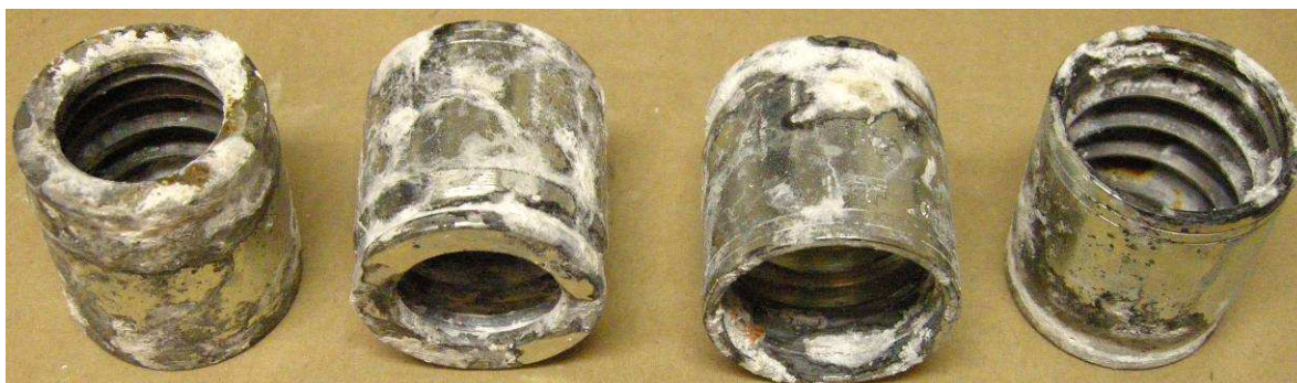
Obr.24. Povrch z kyselé lázně po 360h (známky červené koroze)
