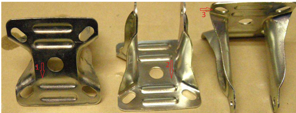
Obr. 30 Měřené body tloušťkoměrem na Držáku pojezdu
