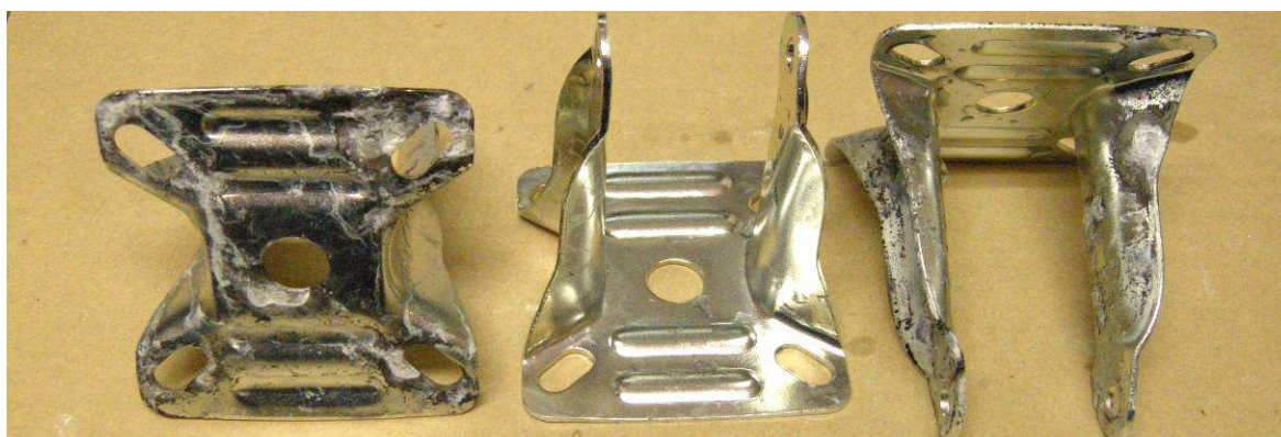
Obr.26. Povrch z kyselé lázně po 144h
