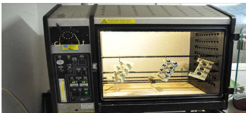
Obr. 17. Solná komora se zavěšenými dílci (koncovka hadice)
