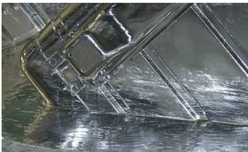
Obr.6 ukázka žárového pokovení
