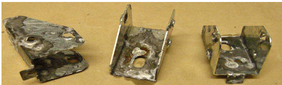
Obr.20. Povrch z kyselé lázně po 264h (známky červené koroze)
