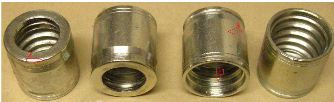
Obr. 31 Měřené body tloušťkoměrem na koncovce hadice
