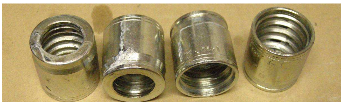
Obr. 23. Povrch z alkalické lázně po 144h (stopy bílé koroze)
