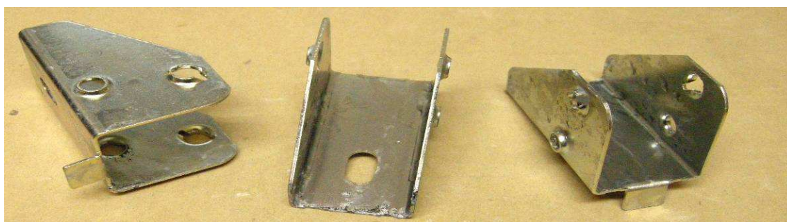
Obr.19. Povrch z alkalické lázně po 144h (stopy bílé koroze)
