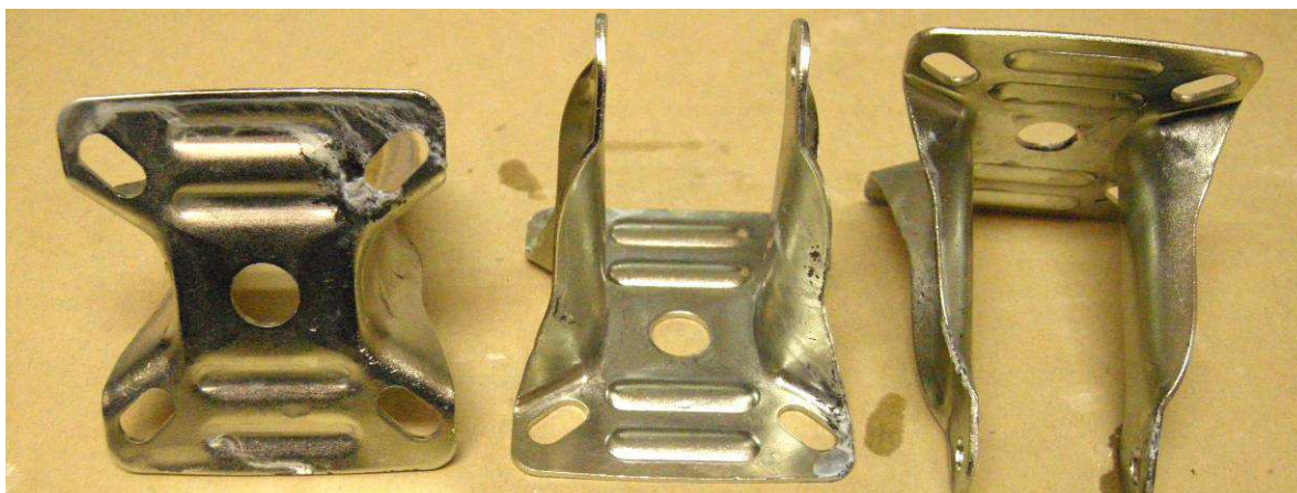
Obr.27. Povrch z alkalické lázně po 144h
