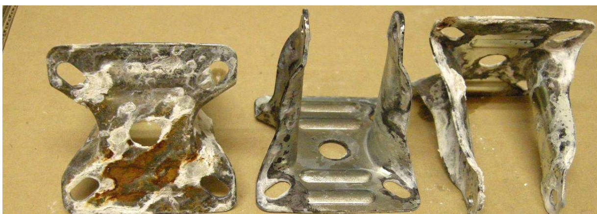
Obr. 29. Povrch z alkalické lázně po 312h
