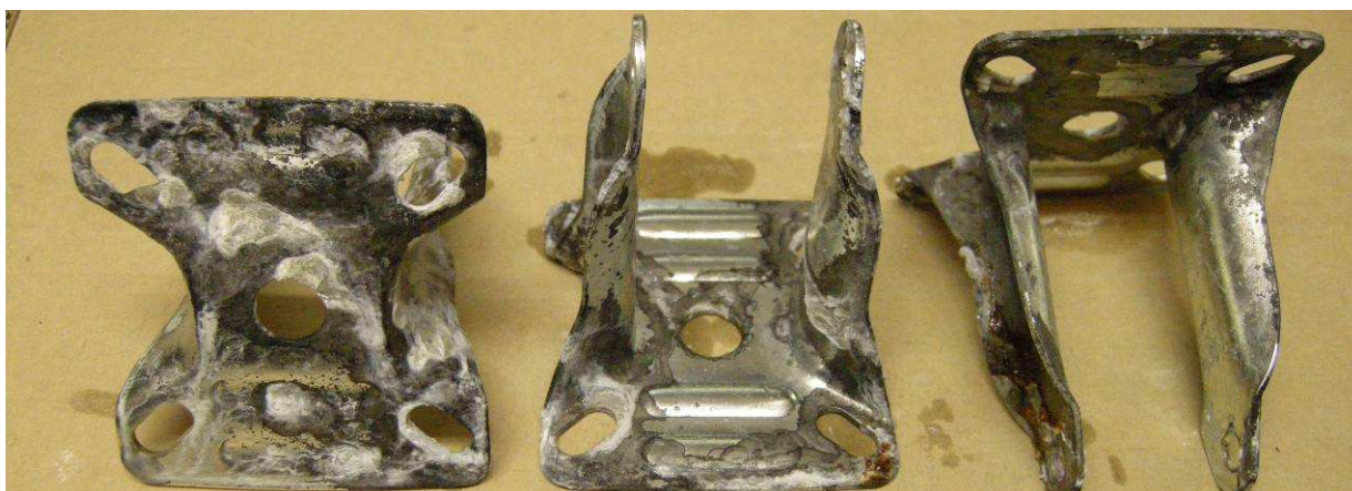
Obr.28. Povrch z kyselá lázně po 264h
