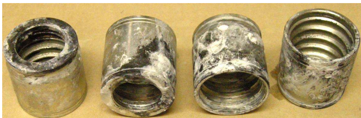
Obr.25. Povrch z alkalické lázně po 408h
