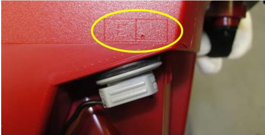
Obrázok 27: Označenie svetla po kladnom vykonaní elektrickej skúšky
