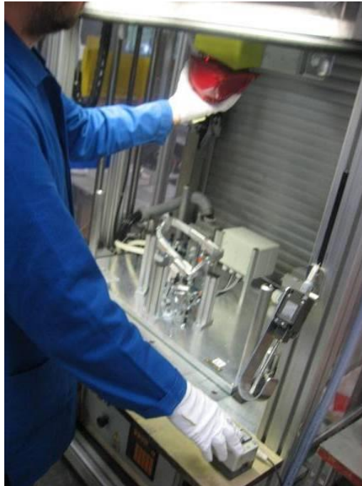
Obrázok 23: Uloženie zvarného svetla do prípravku skúšky tesnosti
