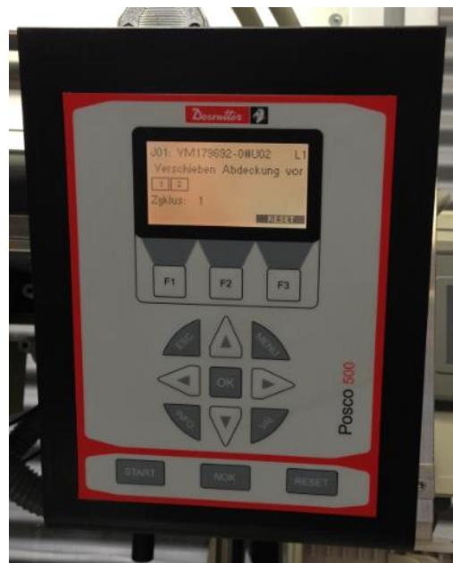
Obrázok 39: Displej skrutkovačky s polohovým senzorem
