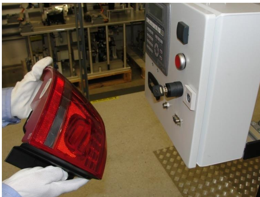
Obrázok 29: Kontrola vytemperovania svetla termo snímačom
