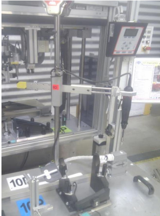
Obrázok 38: Elektrická skrutkovačka s polohovým senzorem
