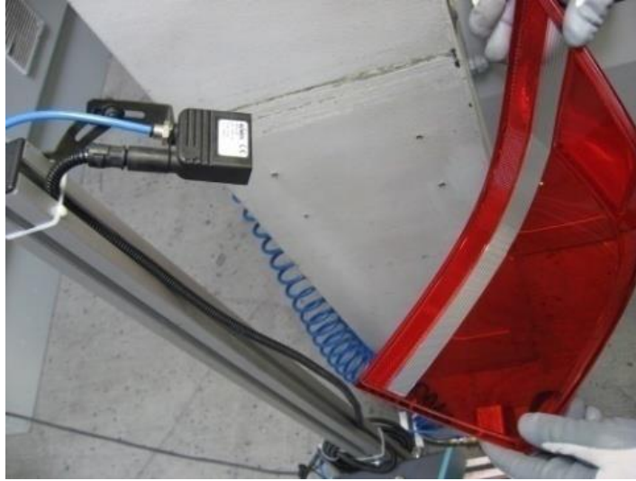
Obrázok 22: Ofúknanie ionizovaným vzduchom
