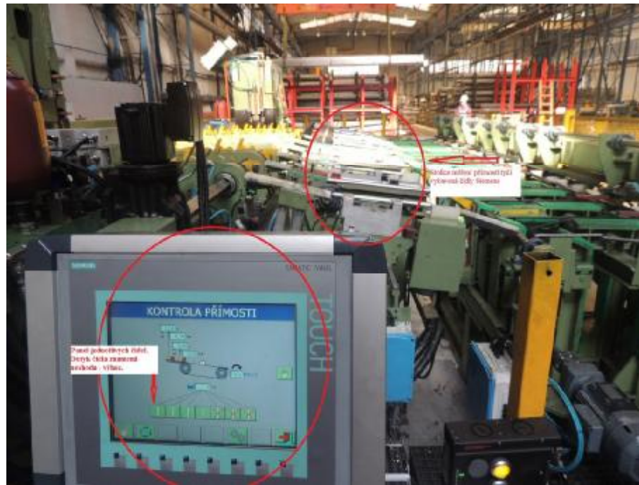
Obrázek 3. 7 Stolice kontroly přímosti. [24]
