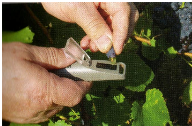
Obrázek 2: Proměrování cukernatosti ručním refraktometrem [10]
