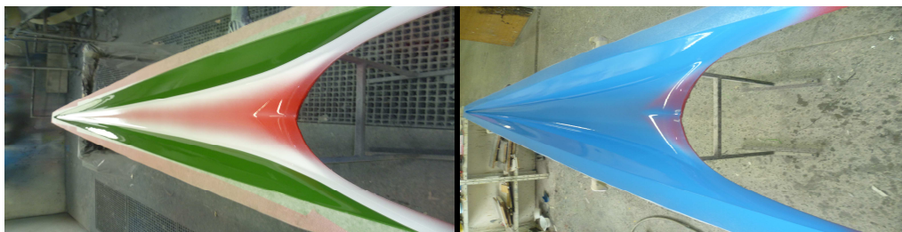
Obr. 18. Možné probarvení gelcoatem, Interní foto fi Havel
