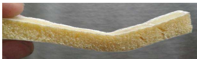
Obr. 34. Vzorek po zkoušce rázové houževnatosti
