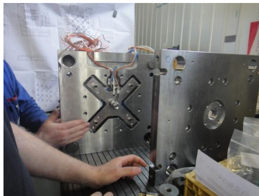
Obr. 30 Horúci rozvod (Vl. foto)
