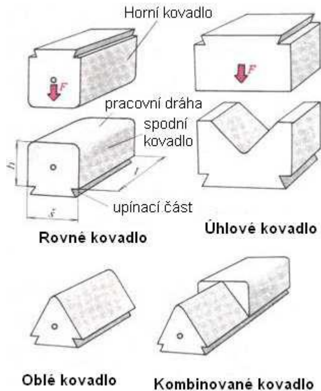
Obr. 18: Tvary kovádel pro volné kování
