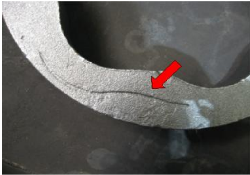
Obr. 21: Zatlačená jehla do výkovku
