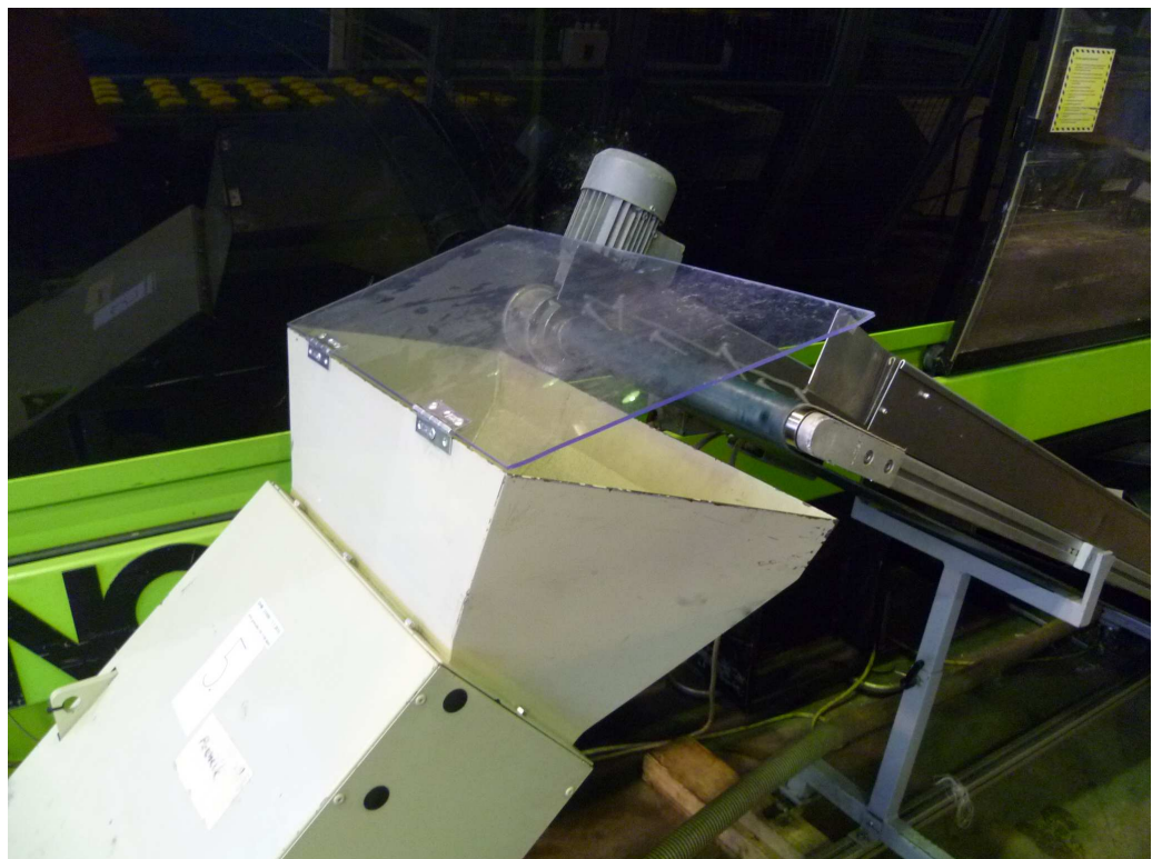
Obr. 37 Drtič zapojený v In-line okruhu
