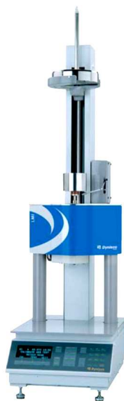
Obr. 33 Výtlačný reometr na měření hmotnostního indexu toku taveniny
