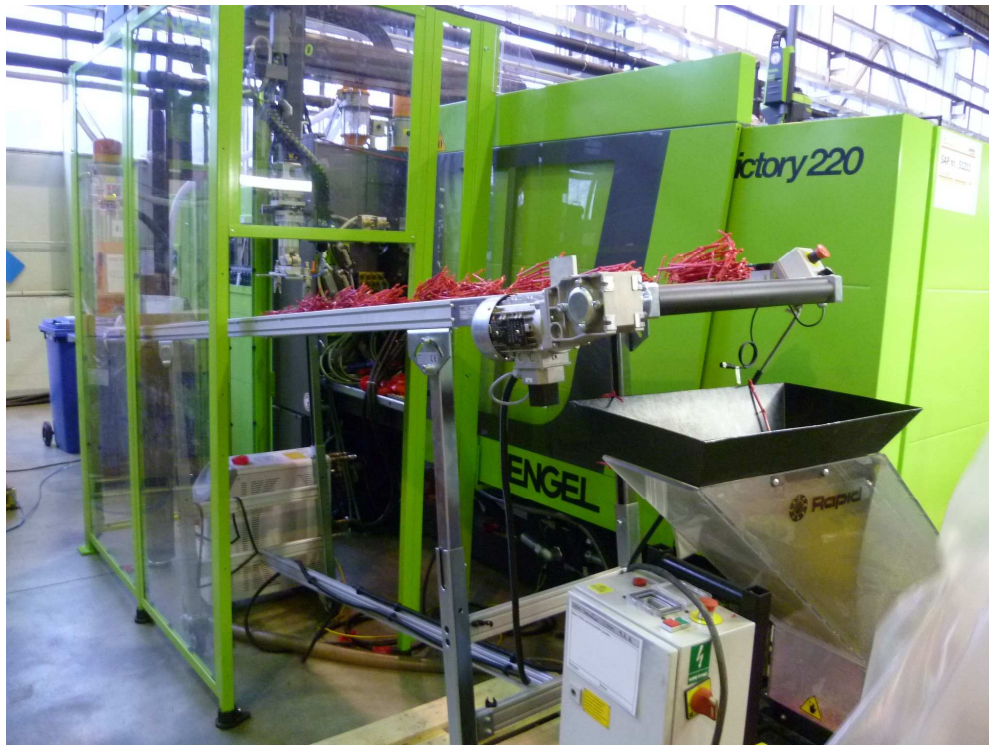
Obr. 47 Drcení vtokového zbytku a opětovné použití u projektu Housing
