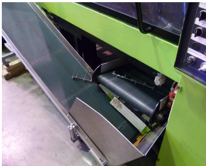
Obr. 43 Drcení vtokového zbytku a opětovné použití u projektu Paluba
