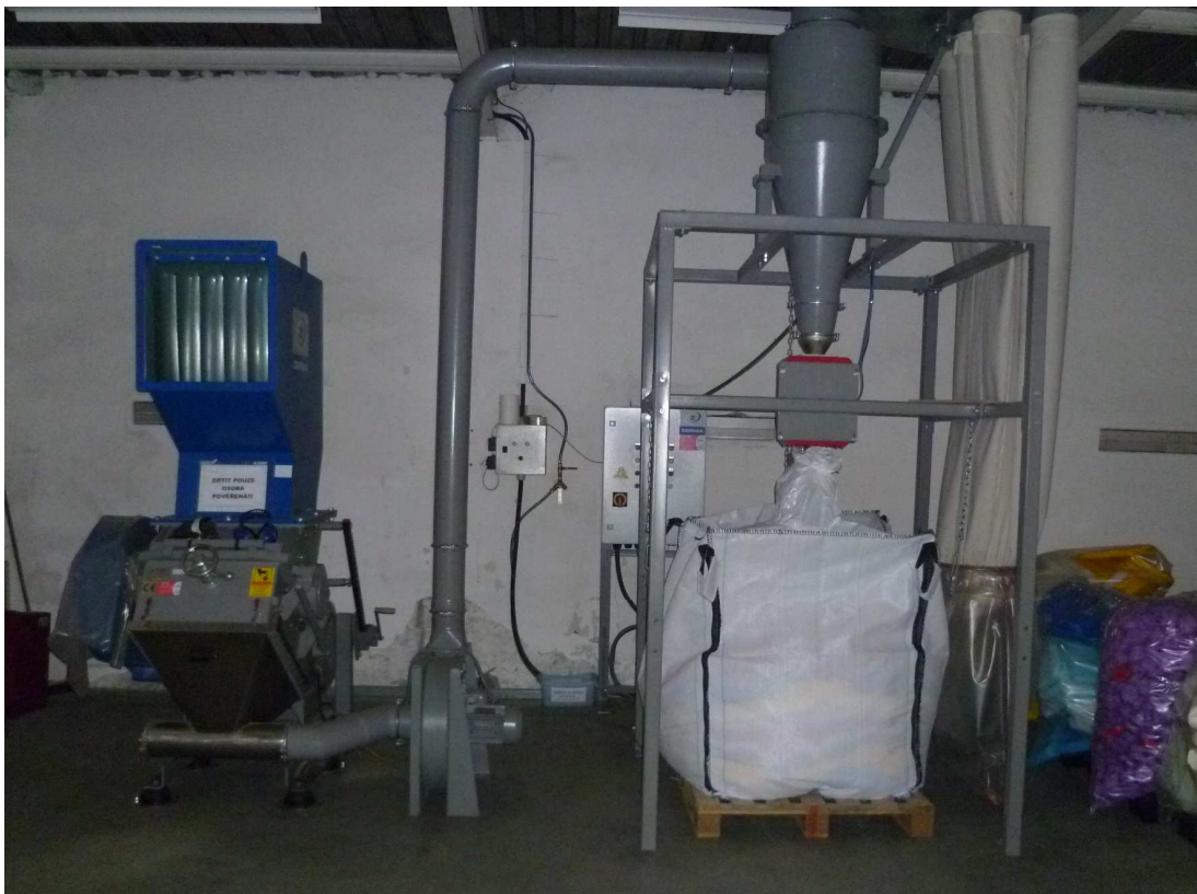
Obr. 38 Pracoviště na drcení nadrozměrných vadných výrobků a vtoků
