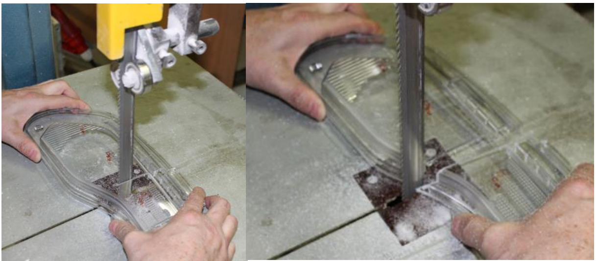
Obr.26 Príprava vzoriek na meranie rezaním
