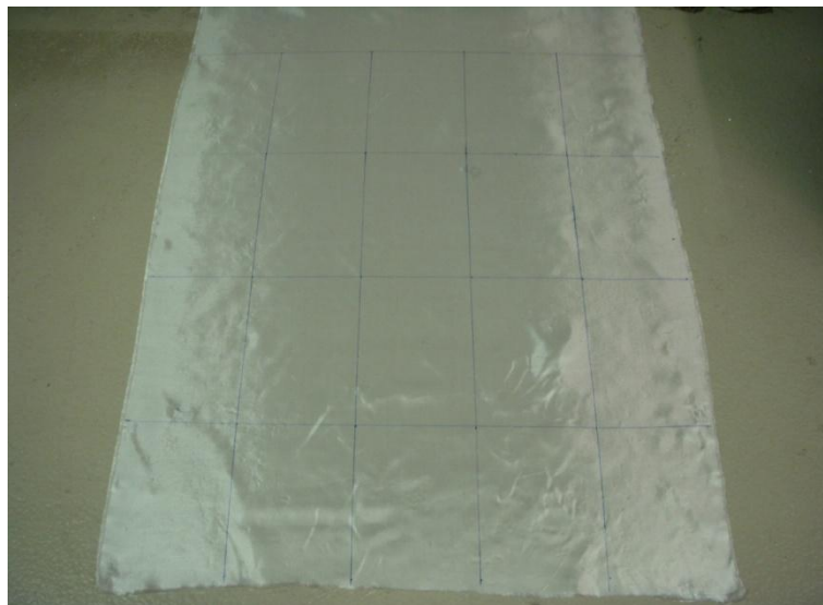
Obr. 17 Příprava skelné tkaniny
