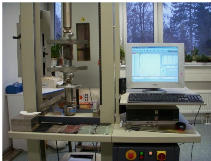
Obr. 38 Ohybová zkouška na stroji ZWICK 1456
