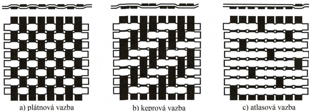
Obr. 8 Nejběžnější druhy vazeb vyztužujících tkanin [3]
