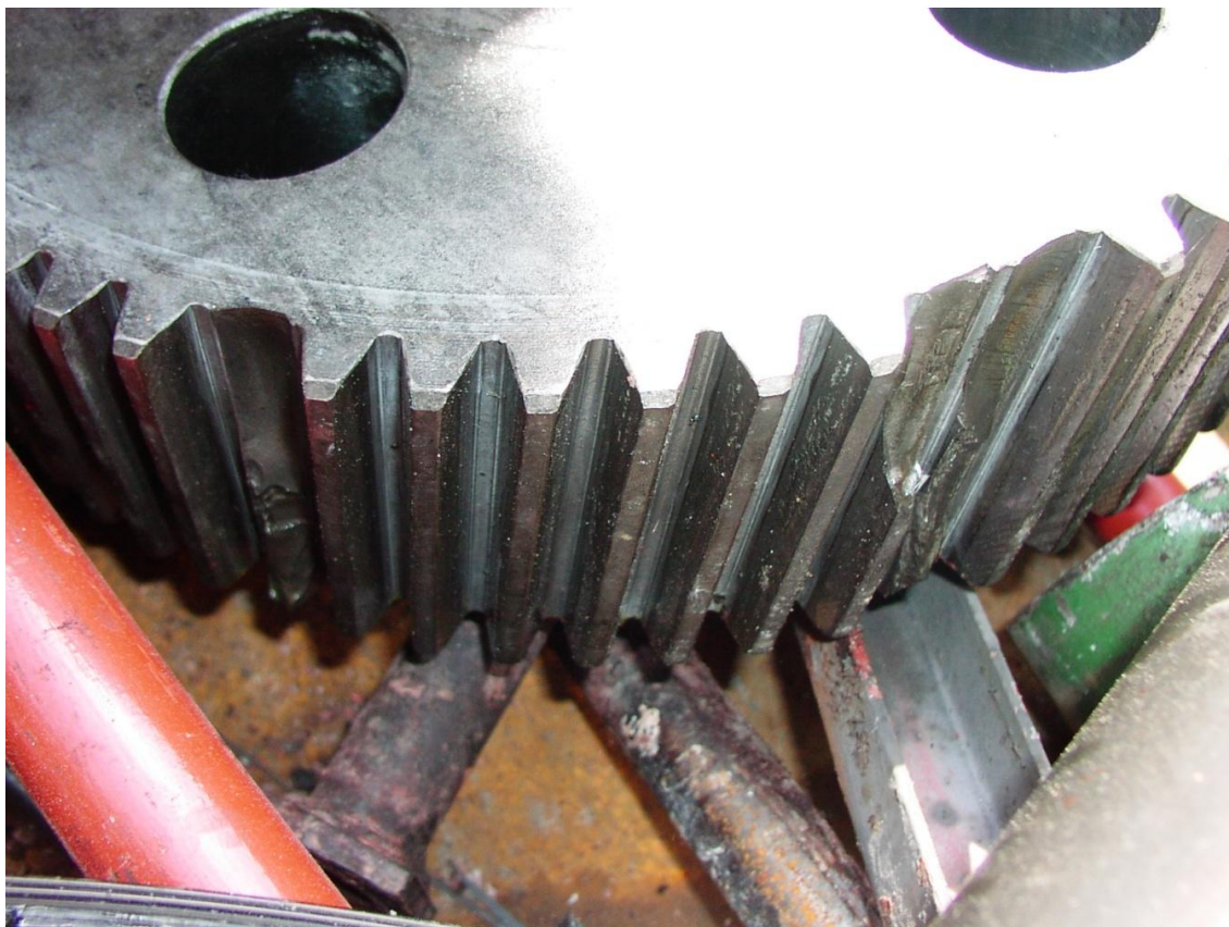
Obr. 35. Fotografie vylomených zubů na ozubeném kole
