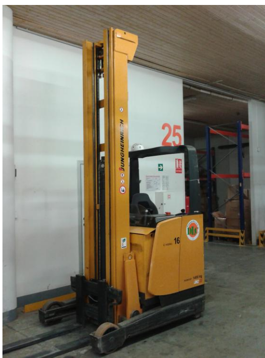
Obr. č. 7. Vysokozdvíhací vozík s výsuvným sloupem [Zdroj vlastní]
