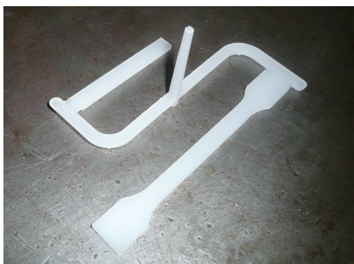
Obr. 45. Ukázka výstřiku a univerzitního vstřikovacího stroje.
