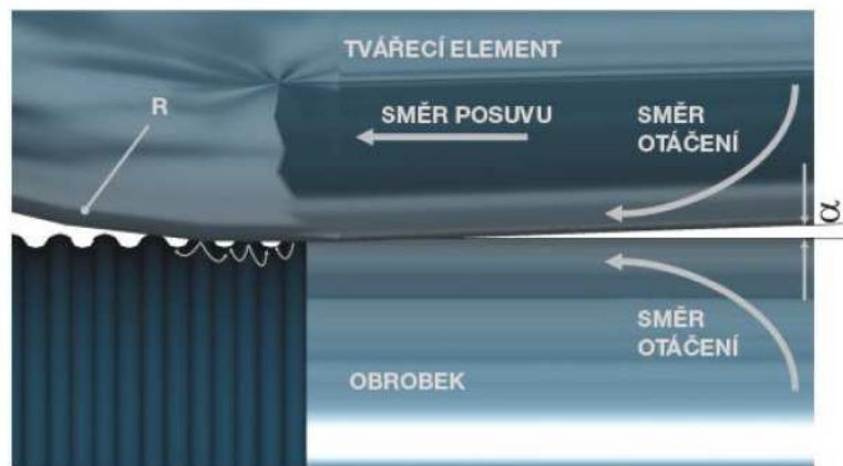
Obr. 17. Schéma průběhu napětí, geometrických a objemových změn materiálu při válečkování [27].
