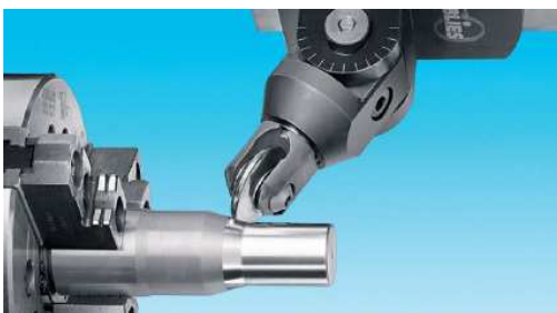
Obr. 18. Statické vnější a nástroj pro dynamické vnitřní válečkování [29,30].
