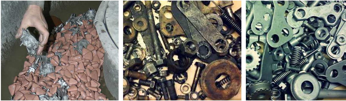
Obr. 15. Pohled na omílací proces a díly před a po omílání [22,24].
