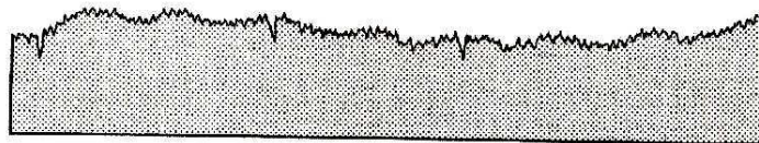
Obr. 22. Skutečný profil povrchu [35].
