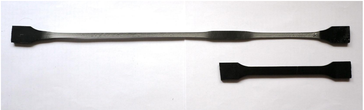
Obr. 13 Maximální natažení vzorku STANDARD při tahové zkoušce
