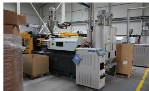
Obrázek 32 Sušičky materiálu (Vl. foto)
