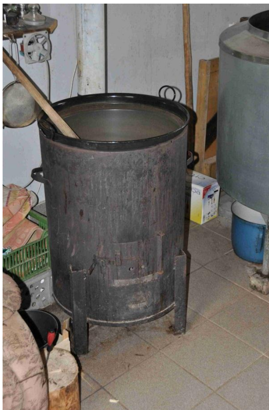
Obrázek 13 Kotel pro ohřev vody 40 litrů (vlastní foto)
