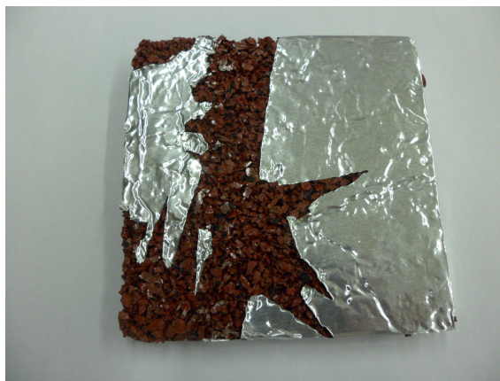
Obr. 28. Ukázka obtížného odstranění alobalové formy ze vzorku
