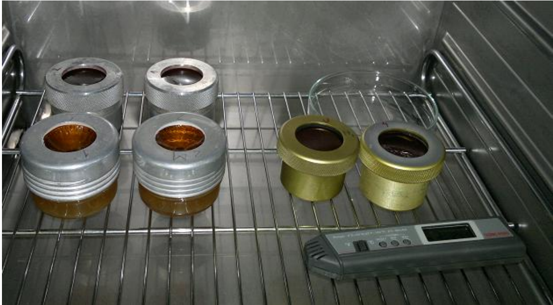
Obrázek 31: Zkouška propustnosti vodní páry v sušárně.
