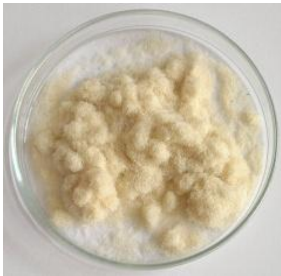
Obrázek 10: Pomletá ovčí vlna na nožovém mlýně.
