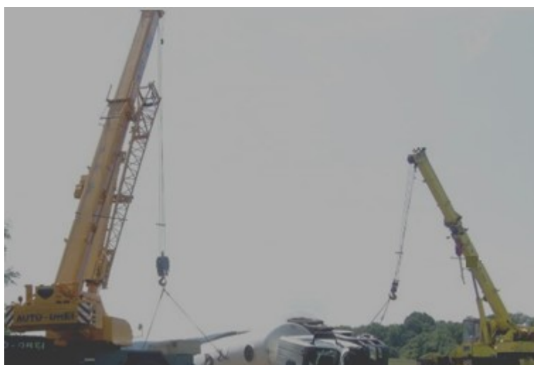
Obr. 20 Vyprošťování cisterny [Zdroj: Hasiči UH]
