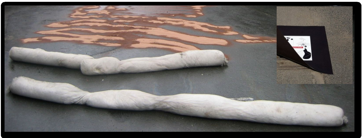
Obr. 12 Sorpční hady se sypkým chemickým sorbentem a kanalizační ucpávku
