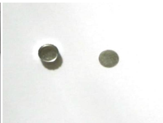
b, vzorek je umístěn do Al kapsle
