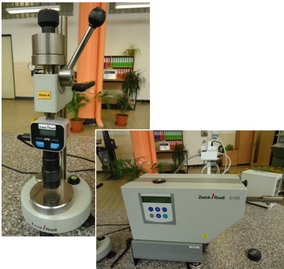
Obrázek 33 - vlevo tvrdoměr, vpravo stroj k určení odrazové pružnosti
