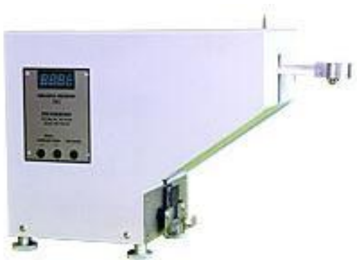
Obrázek 27 přístroj k měření odrazové pružnosti
