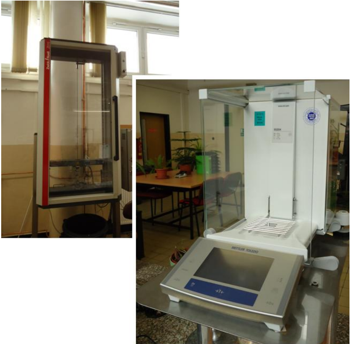
Obrázek 32 vlevo trhací stroj, vpravo hydrostatické váhy pro měření hustoty
