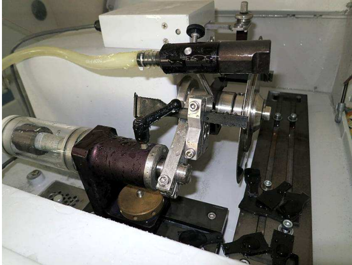
Obr. 37: Řezání vzorků na stroji Buehler Isomet 4000
