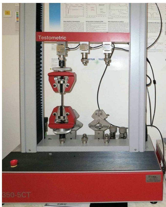
Obr. 40: Zařízení pro tahovou zkoušku – Testometric M350-5CT
