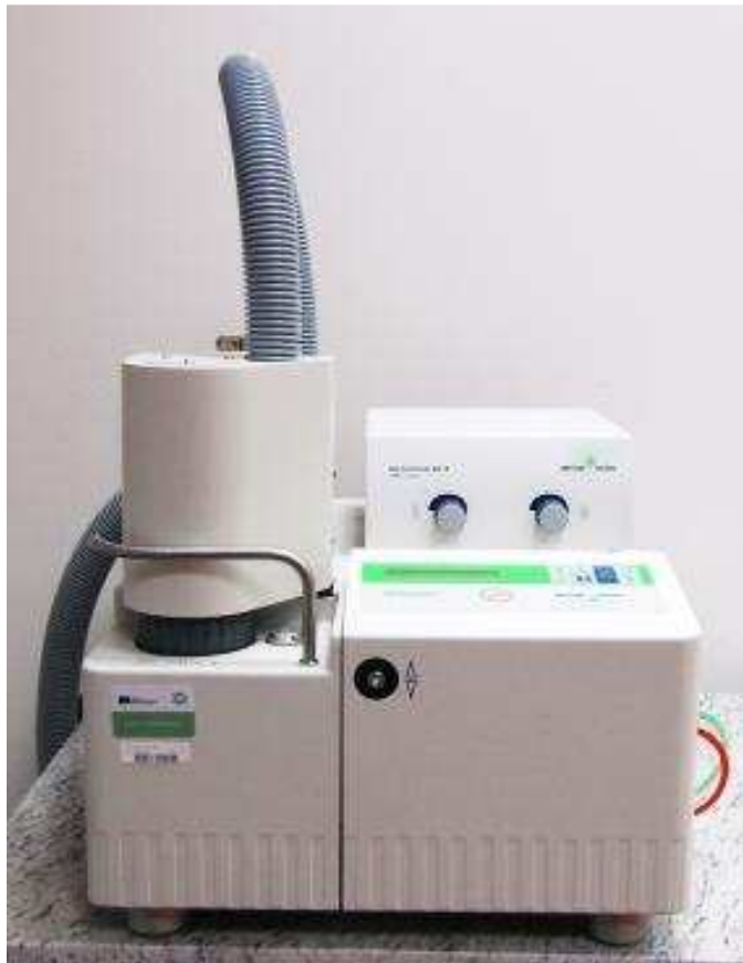
Obr. 42: Termomechanický analyzátor TMT SDTA841e
