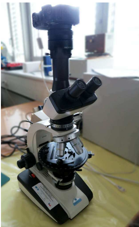
Obr. 39: Optický polarizační mikroskop Intraco Micron s digitálním fotoaparátem Canon G10
