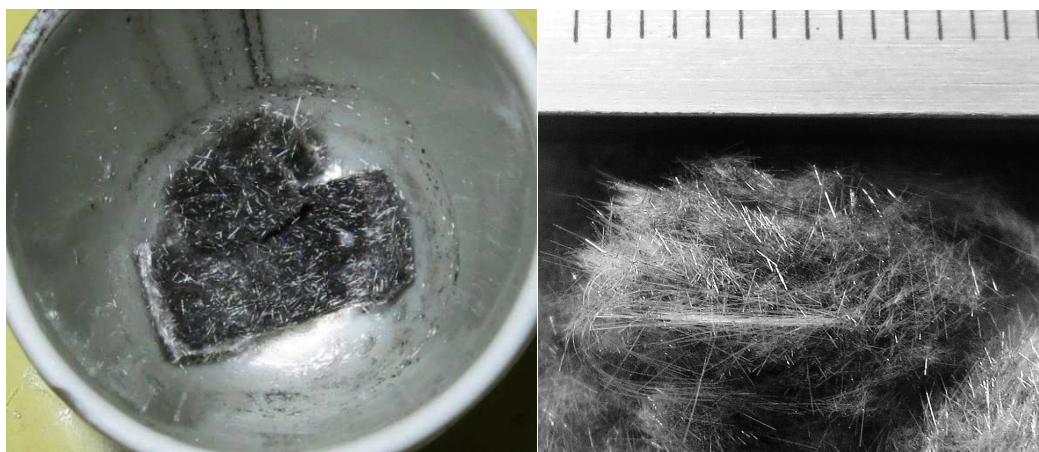
Obr. 43: Zbytek po spálení vzorku č. 1 před a po rozpadnutí skeletu (jeden dílek na měřítku odpovídá 1 mm)
