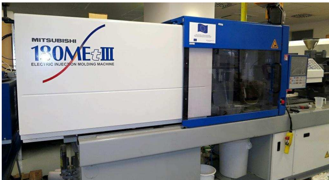
Obr. 35: Vstříkovací stroj Mitsubishi 180MEtIII
