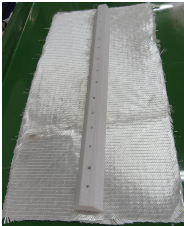
Obr. 32. Dvě spodní vrstvy tkaniny a pěnové žebro
