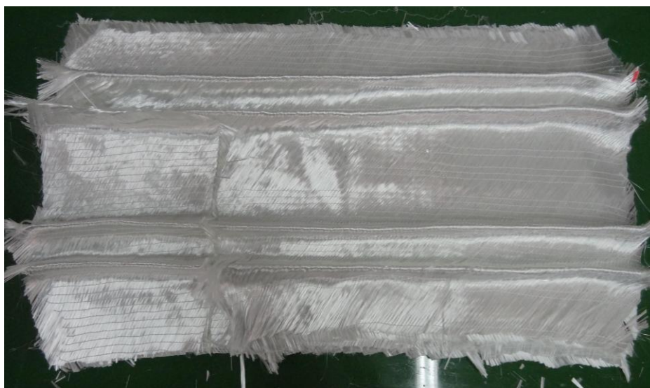
Obr. 42. Horní vrstva skelné výztuže založená do profilu „U“
