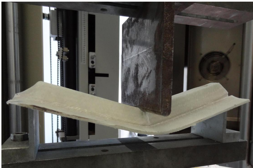
Obr. 51. Provedení ohybové zkoušky
