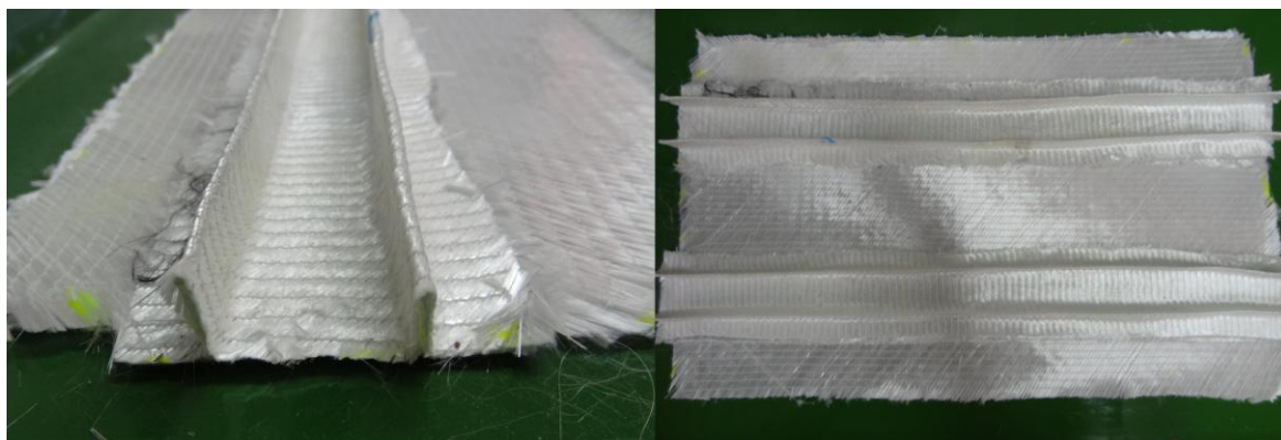
Obr. 41. Detail „U“ profilu a pohled shora
