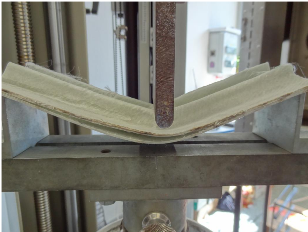
Obr. 53. Delaminace při provedení ohybové zkoušky
