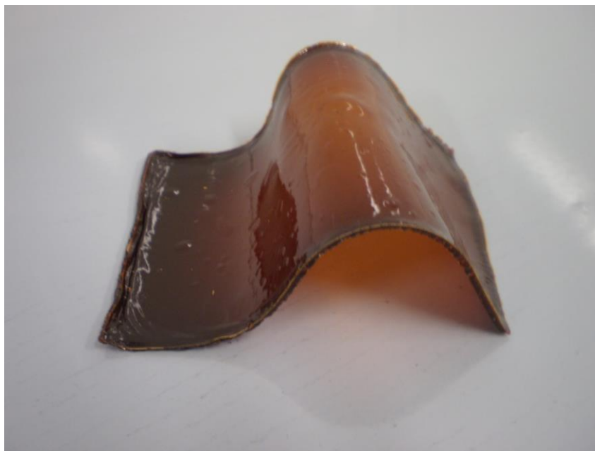
Obr. 13: Folie s 30 % glycerolu jako změkčovadla v ohybu
