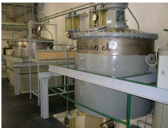
Obr. 17. Rozpuštěcí nádoby pro přípravu roztoků azidu sodného a dusičnanu olovnatého [24]
