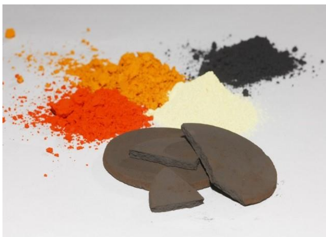
Obr. 4 Suroviny pro výrobu zp. složí a tableta zp. slož [24]
