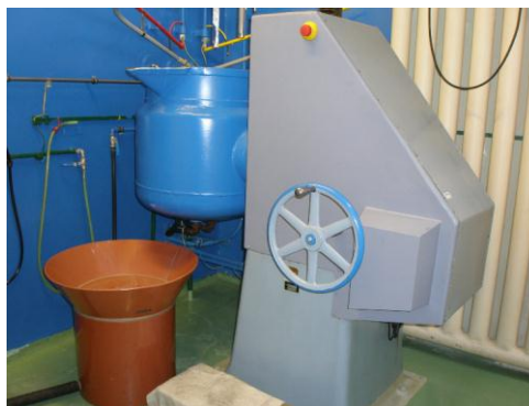
Obr.12. Srážecí nádoby ke srážení azidu olovnatého [24]
