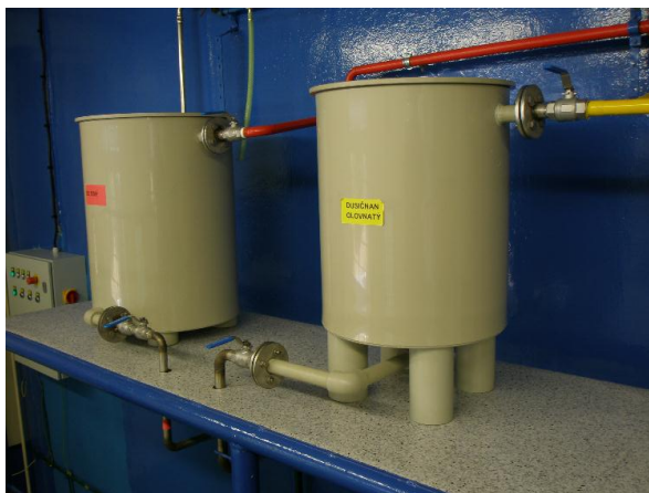
Obr.11. Přepouštěcí nádoby zásobních roztoků azidu sodného a dusičnanu olovnatého [24]
