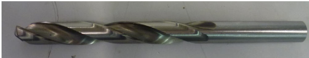
Obrázek 33 – Vrták průměr 11mm
