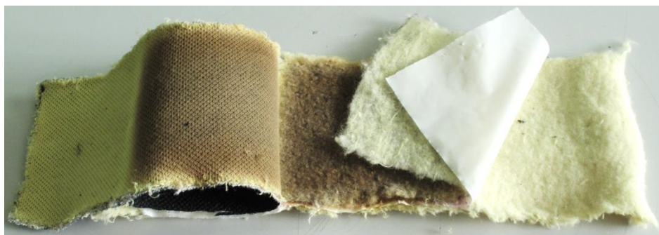
Obr. 70 – Nejvíce degradovaná kompozice – skladba G
