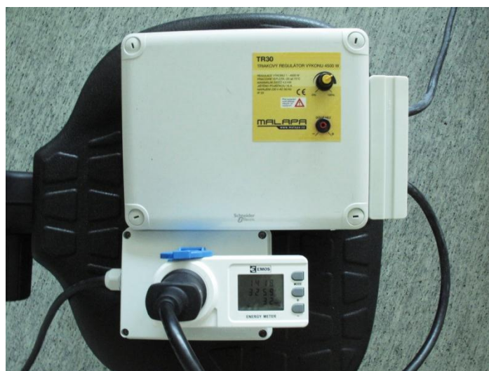
Obr. 30 – Příklad měřicího aktuálního dodávaného příkonu s regulátorem
