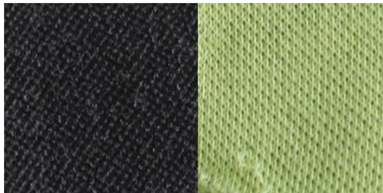
Obr. 42 – Aramidová úplet se silikonovým zátěrem – lícová a rubová strana
