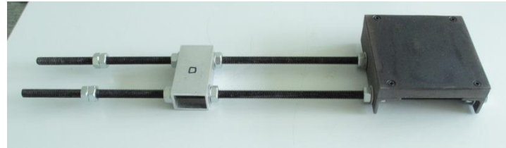
Obr. 33 – Držák zkušebních vzorků určený pro metodu B
