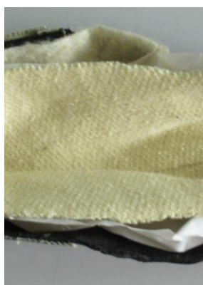
Obr. 60 – Ukázka pořadí vrstev ve vrchové a dlaňové části HZR
