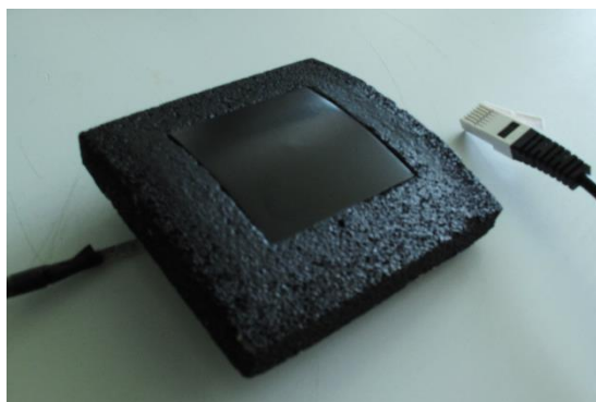
Obr. 36 – Základová nosná deska s kalorimetrem
