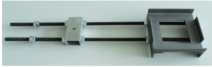
Obr. 32 – Držák zkušebních vzorků určený pro metodu A
