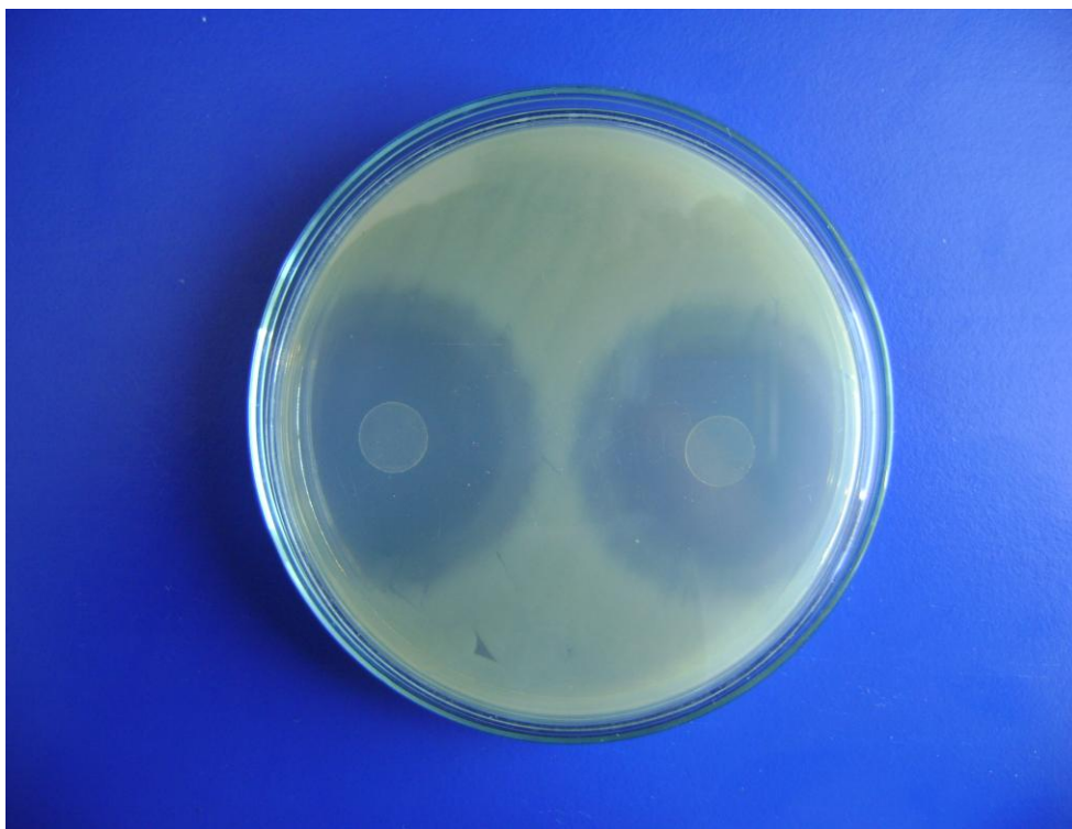
Obrázek 13: Vzorek PE po plazmové úpravě + AAM + NORFLOXACIN a Escherichia coli
