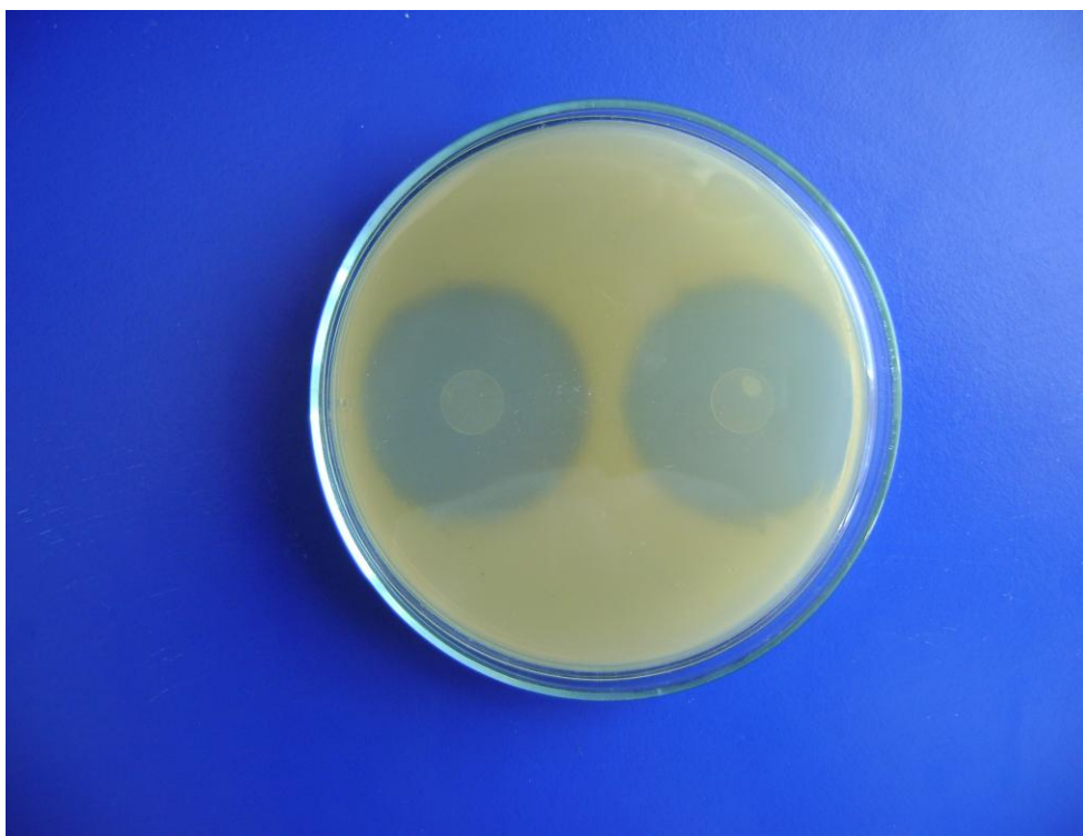
Obrázek 16: Vzorek PE po plazmové úpravě + AAM + NORFLOXACIN a Staphylococcus aureus .
