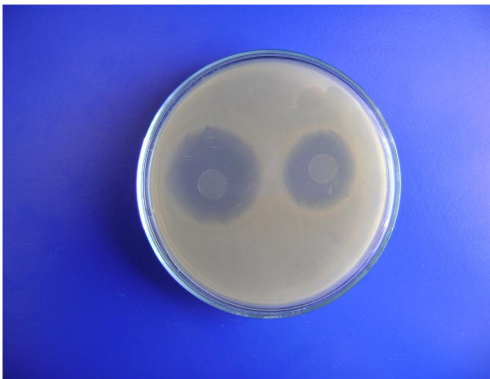
Obrázek 10: Vzorek PE po plazmové úpravě + AAM + CIPROFLOXACIN a Esherichia coli .
