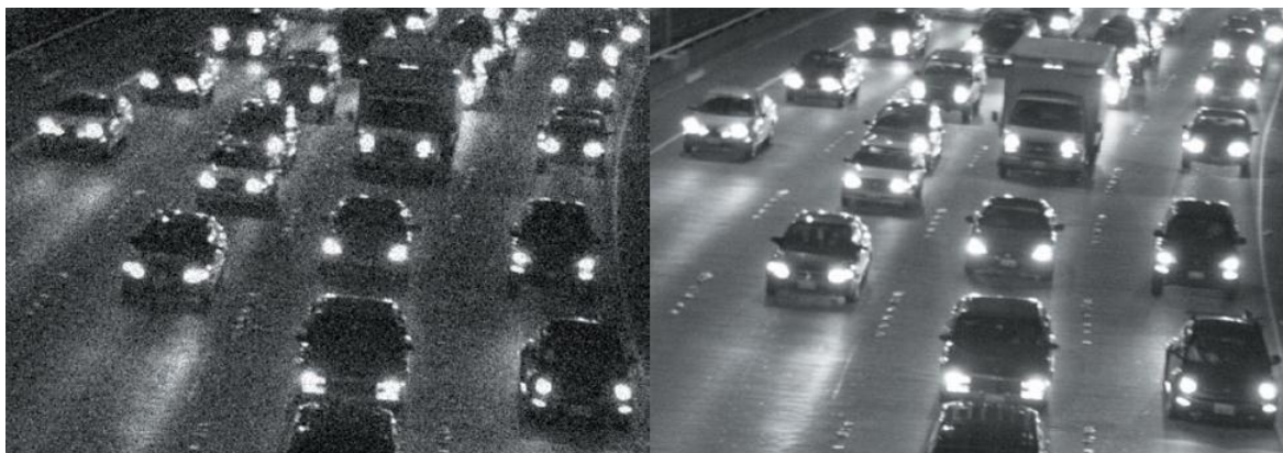
Obr. 14 – Porovnání snímků před a po použití funkce 2D/3D NR, zdroj: http://www.viakom.cz
