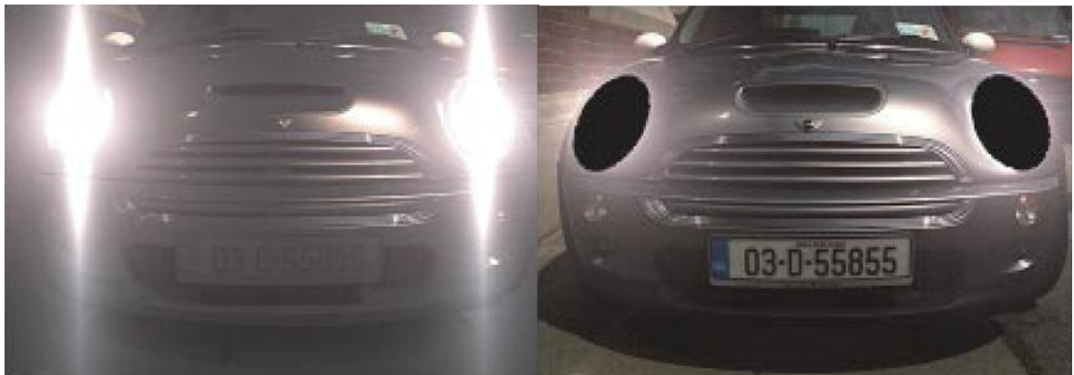
Obr. 16 – Porovnání snímků před a po použití funkce Highlight Eclipse, zdroj: http://www.viakom.cz
