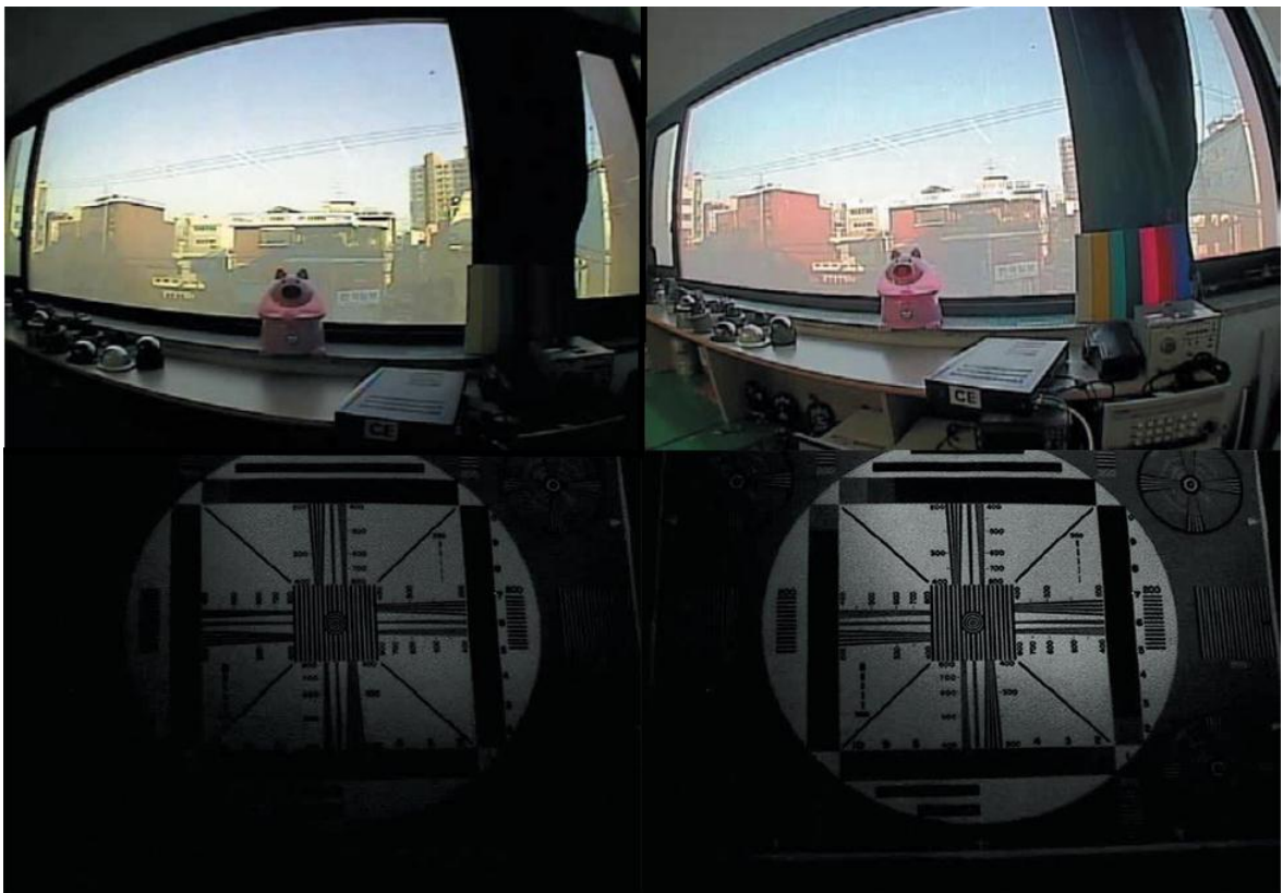
Obr. 15 – Porovnání snímků před a po použití funkce sWDR, zdroj: http://www.viakom.cz
