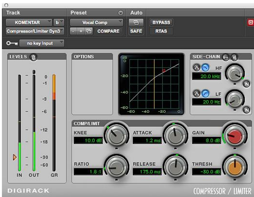
Obr. 17: Ukázka Kompresoru/Limiteru nastaveného na mluvené slovo
