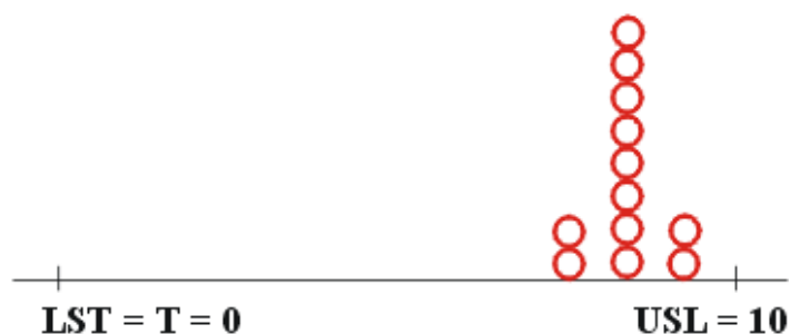
Obrázek 31. Tolerance typu S : dobré centrování [13]
