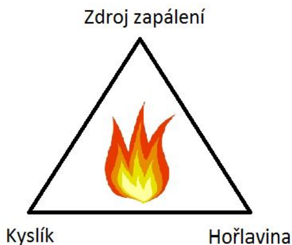
Obr. 1: Schematické znázornění podmínek procesu hoření
