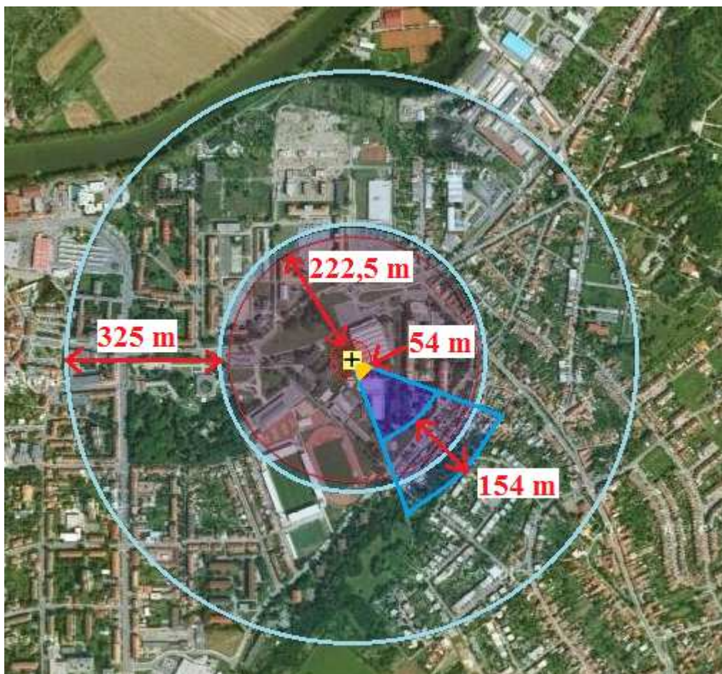
Obr. 19. Porovnání dlouhodobého a částečného úniku.
