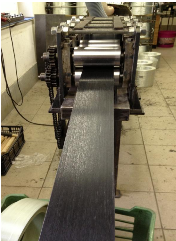
Obrázek 19 Uskutečnění odtahu pultruzní linky pomocí ocelových válců 1.
