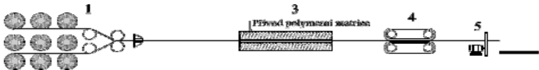
Obrázek 16 Nákres pultruzní linky s přímým přívodem pryskyřice do pultruzní hlavy a odtahem pomocí pásů
