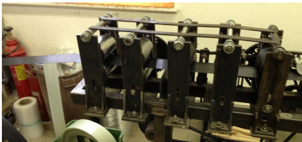
Obrázek 20 Uskutečnění odtahu pultruzní linky pomocí ocelových válců 2.
