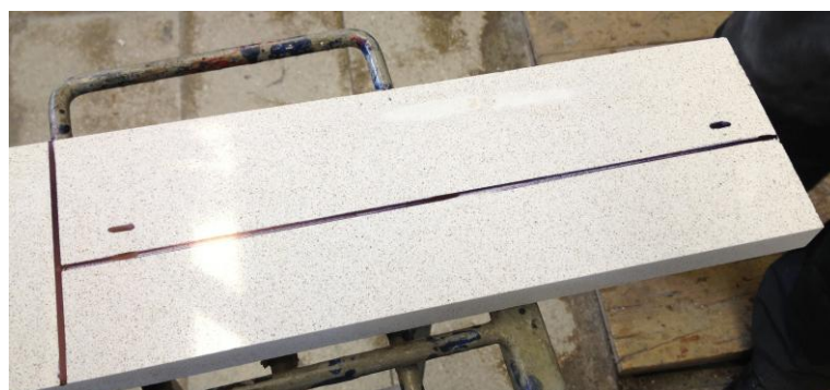
Obrázek 23 Orysování mramorové desky na rozměr testovaného vzorku
