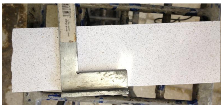
Obrázek 22 Příprava mramorové desky pro testování
