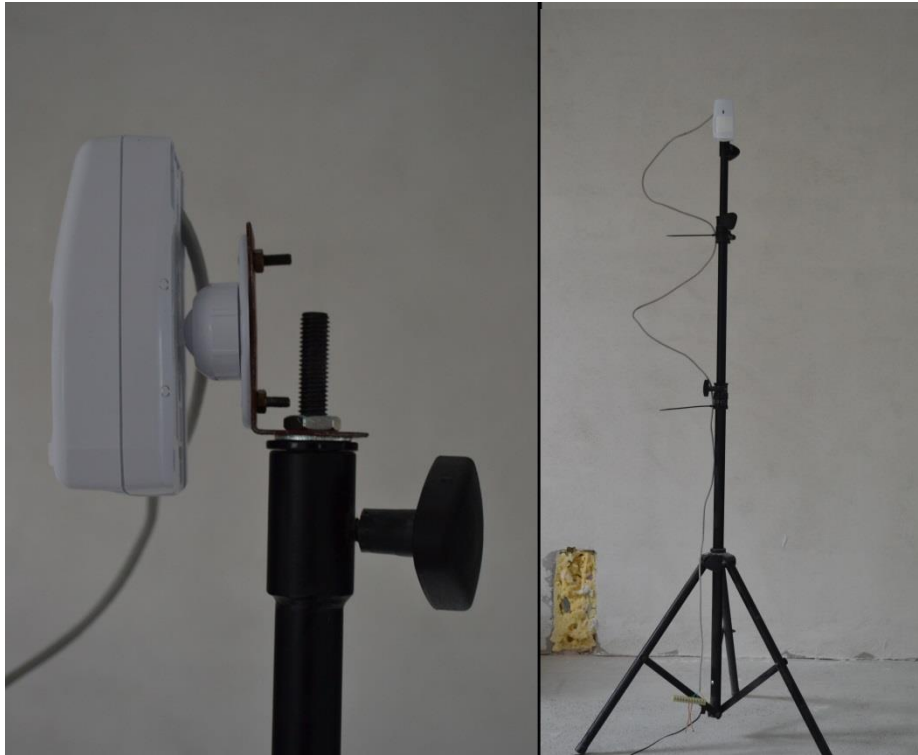
Obrázok 18: Vľavo uchytenie za pomoci kľbového držiaka a prípravku, vpravo pripevnenie na teleskopickom stojane
