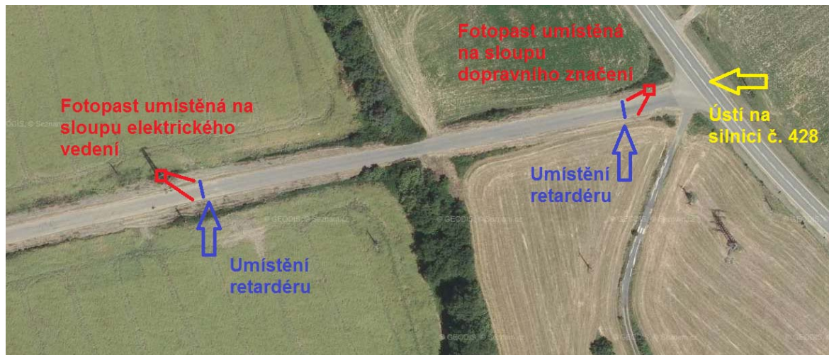
Obr. 20. Umístění fotopasti na sloup elektrického vedení (vlevo) nebo nainstalovaný sloup (vpravo) [Zdroj vlastní]
