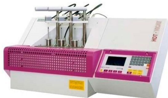
Obr. 43. Zkušební zařízení HDT3 Vicat. [59]
