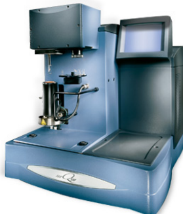
Obr. 45. Zkušební zařízení TGA Q500. [56]
