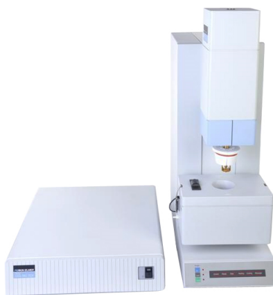
Obr. 44. Zkušební zařízení DMA 7e PERKIN ELMER. [43]
