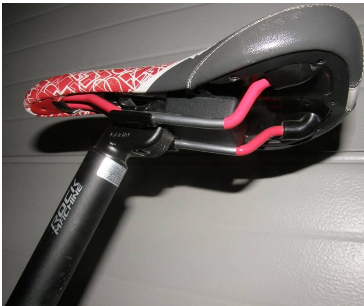
Obrázek 48 Instalace GSM lokátoru
