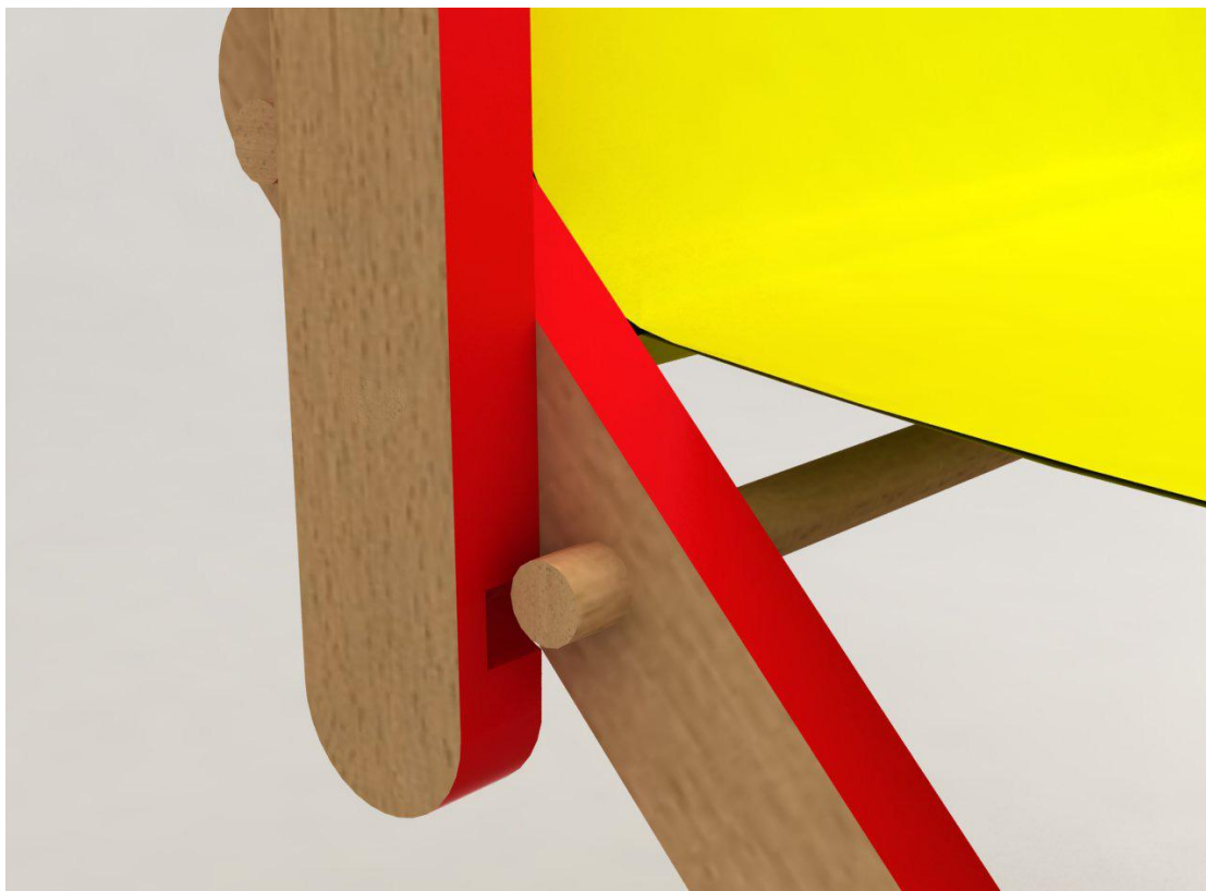
Obrázek 45. Vyfrézované výřezy v opěrátku
