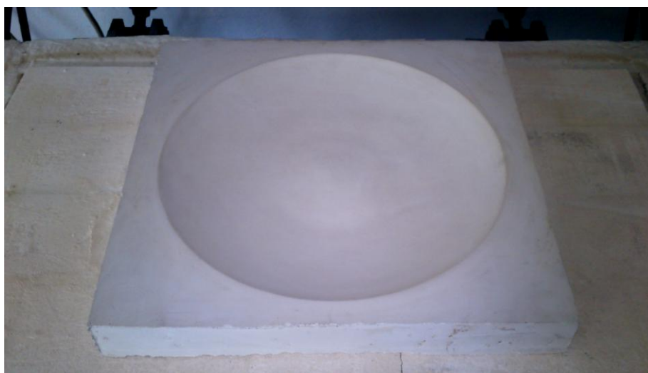
Obr. 47 Forma ze sádky a sklářského písku připravená ve fusingové peci
