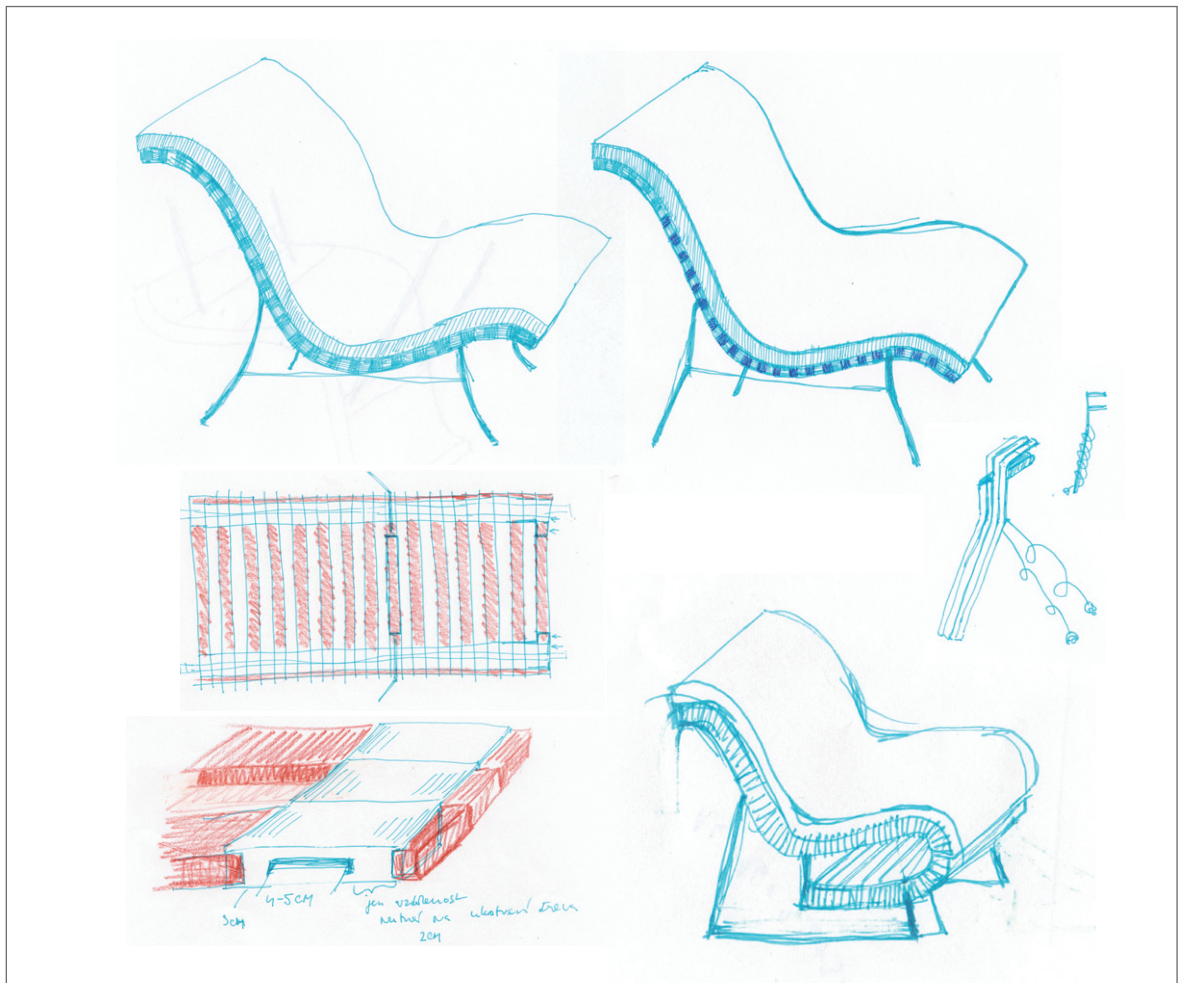
Obr. 72.: Kresby technických řešení; tvar nohou a způsob jejich provázání pomocí ocelových lanek; nohy v rozloženém stavu; skica lamelového roštu s pásem uvnitř a znázornění jiné možné varianty práce s ohebnou konstrukcí
