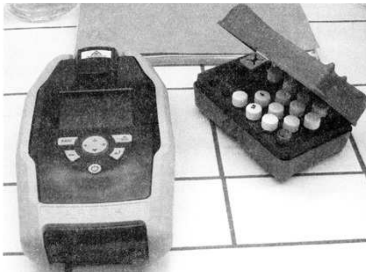
Obr. 13. Přenosný Ramanův spektrometr FirstDefender [20]
