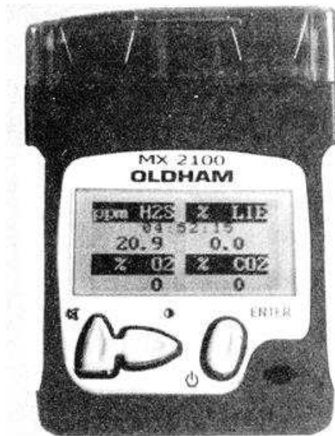
Obr. 10. Multidetektor plynů Oldham MX2100 [20]
