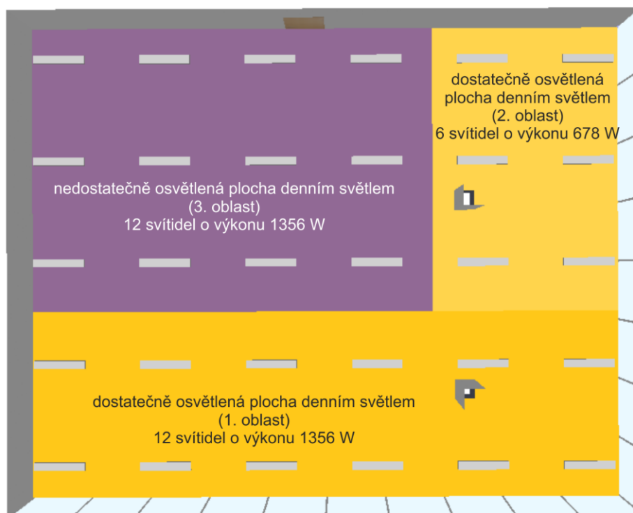
Obr. 75 Rozdělení místnosti na plochy podle osvětlení
