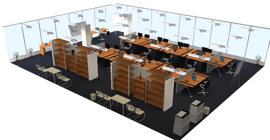
Obr. 60 Vizualizace sruženého osvětlení směrem k prosklené části
