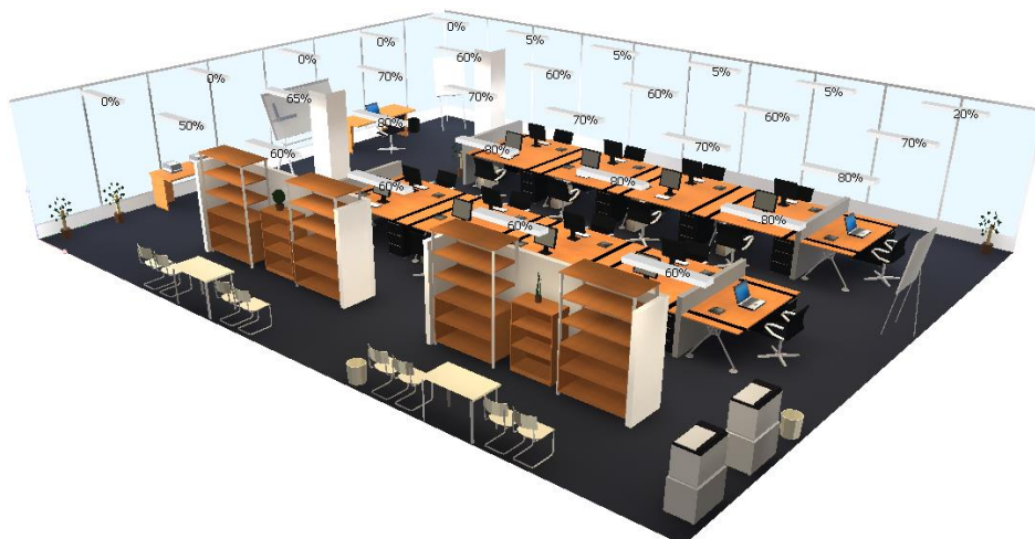
Obr. 72 Vizualizace sruženého osvětlení směrem k prosklené části
