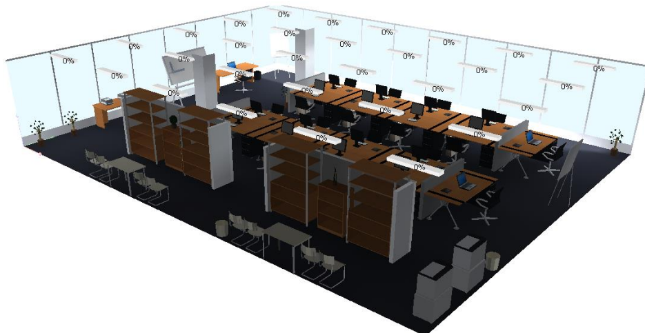
Obr. 49 Vizualizace denního osvětlení směrem k prosklené části
