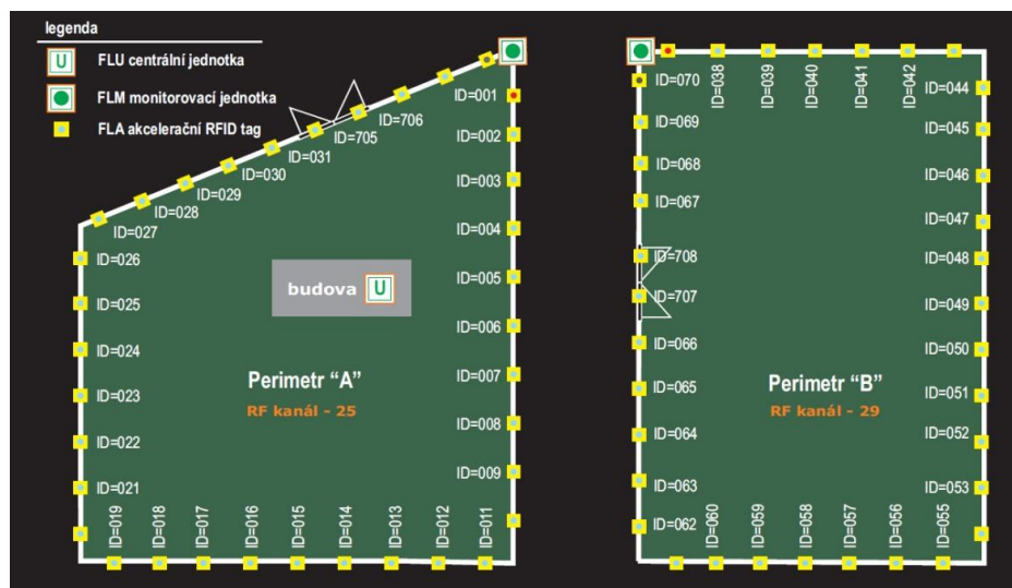
Obr. 22 Architektura s několika perimetry [21]
