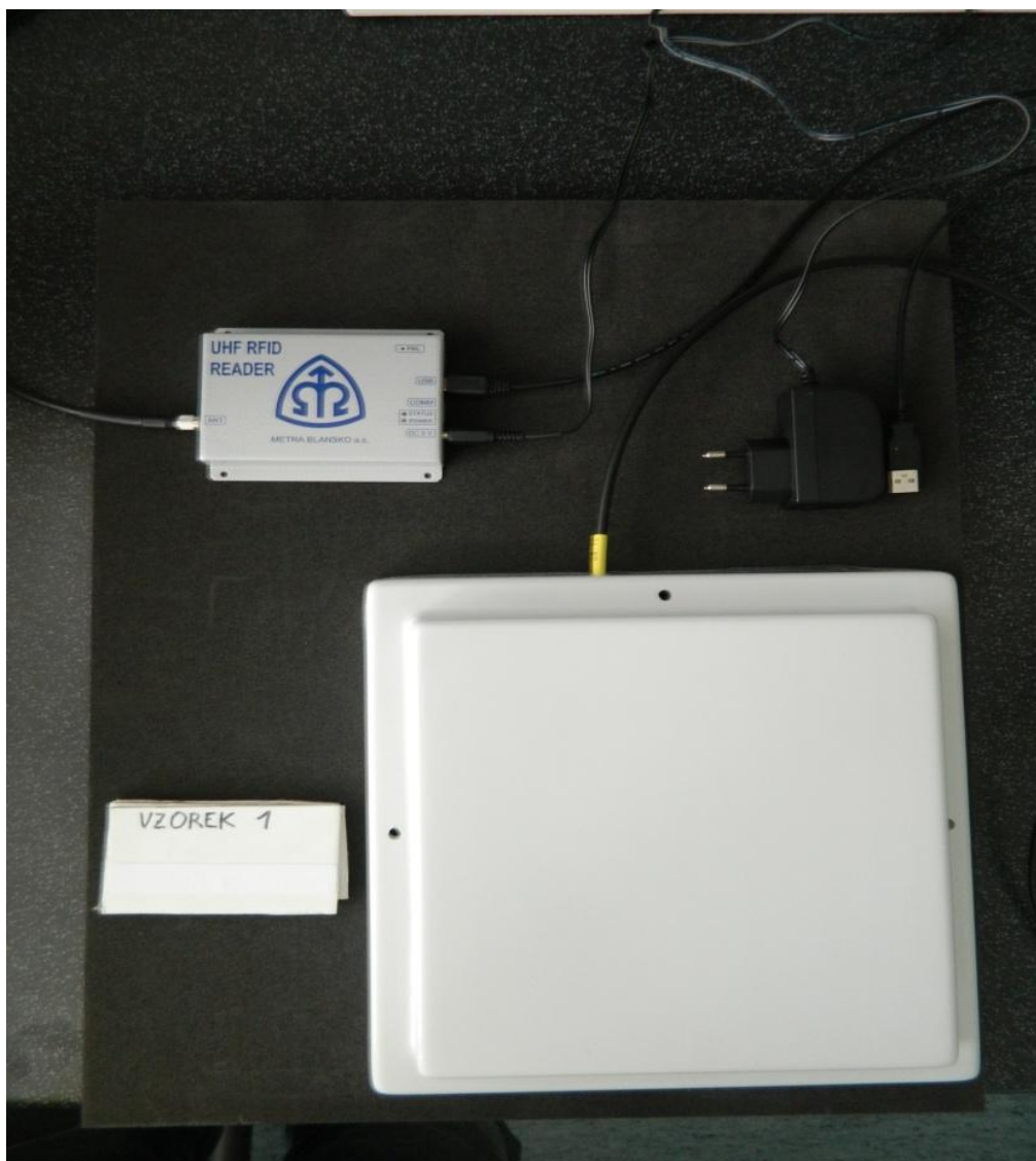
Obr. 38 Zapojení vývojového kitu RFI21.1 s UHF RFID tagy
